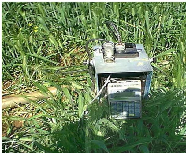
**Photo n°1 .** Humidimètre à neutrons (modèle TROXLER 4300) ayant servi pour le suivi des humidités du sol en profondeur
