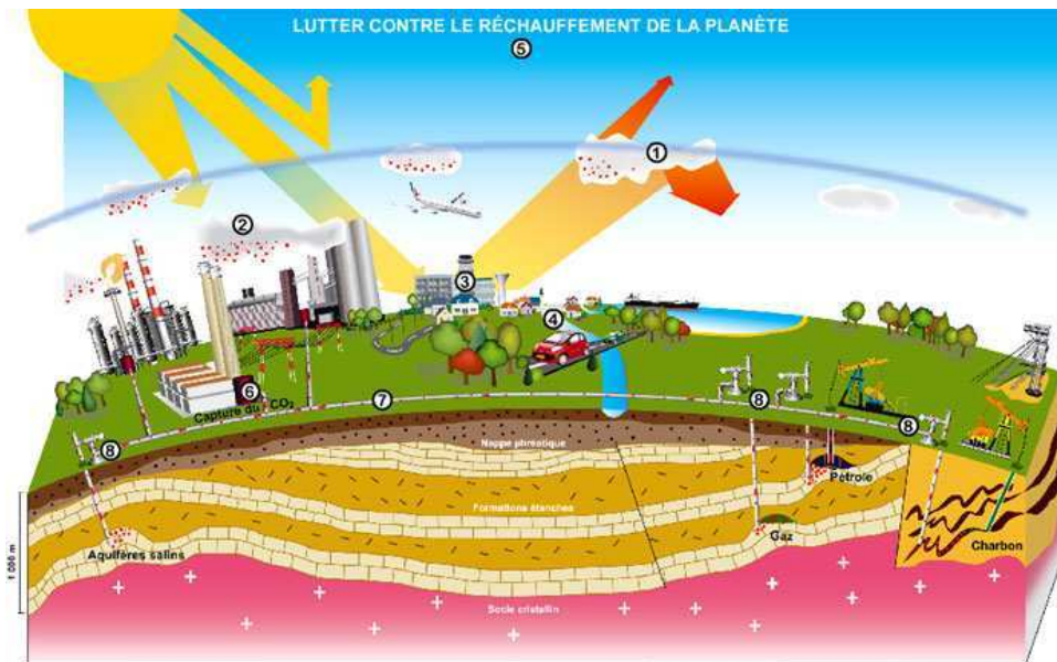
Fig 1. Stockage géologique du CO 2 (source : http://brgm.fr )
