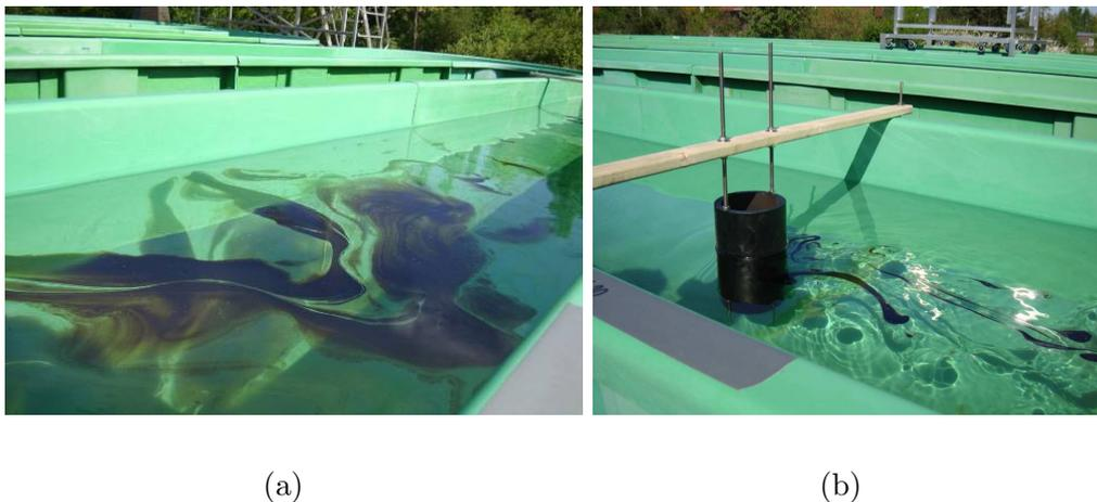
**Figure 5.11:** Observation de la nappe d'hydrocarbures à la surface de la rivière artificielle, sans obstacle (a) et avec obstacles (b)
