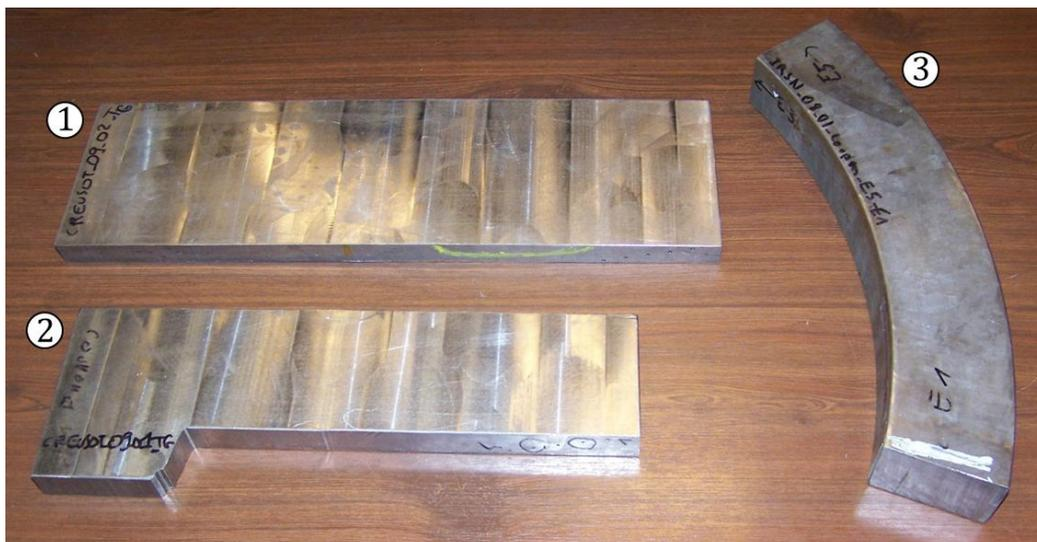
**Figure 2.3** : Photographie des trois pièces en acier utilisées lors des campagnes expérimentales. (1) et (2) correspondent aux échantillons en acier forgé austénitique, tandis que l'échantillon (3) correspond au tronçon en acier moulé austéno-ferritique.
