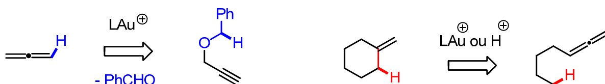
Schéma 181: Préparation et hydrofonctionnalisation d'allènes par transfert d'hydrure 1,5
