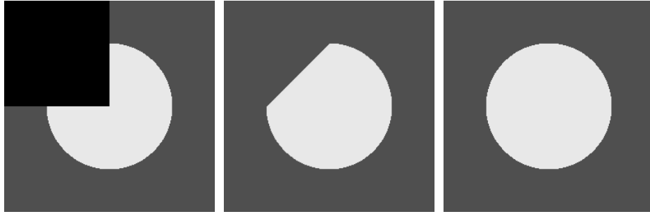
FIG. 1.4: A gauche, la zone en noir doit être recouverte, restauration par minimisation du périmètre et restauration avec prise en compte de la courbure respectivement.
