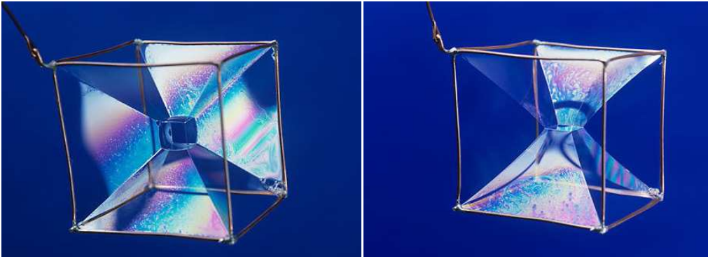
FIG. 1.3: Deux surfaces minimales qui résolvent le problème de Plateau.
