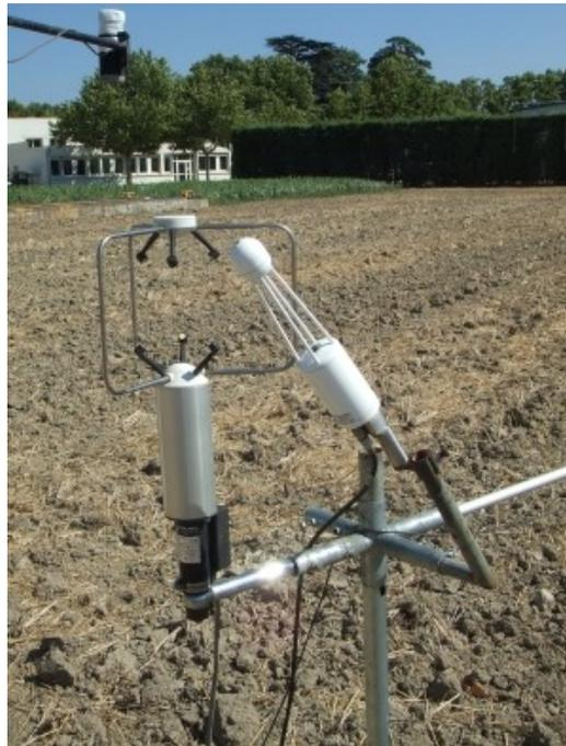
**Figure V.14 :** *dispositif expérimental pour la mesure des flux par corrélation turbulente. A droite l'analyseur de gaz en espace libre (LI-7400), à gauche l'anémomètre sonique Young 84000 et en haut les pyranomètres.*
