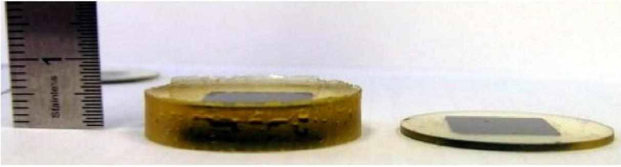
FIGURE 3.10 – VACNTs imprégnés dans le polymère (gauche : avant polissage ; droite : après polissage).
