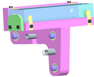
FIGURE 9.20 – Vue de détail du système de positionnement "trait-point-plan" des miroirs.
