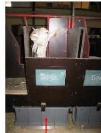
Auge placée sur jauge de contrainte (Desnoyers et al., 2008) Mesure de la quantité dans l'auge toutes les 2 min
