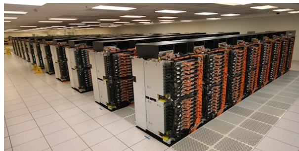
FIGURE 2 Le plus grand supercalculateur à ce jour, Sequoia , du laboratoire Lawrence Livermore (USA), comptabilise 1,5 M d'unités de calcul pour une puissance de 16 Pflops.
