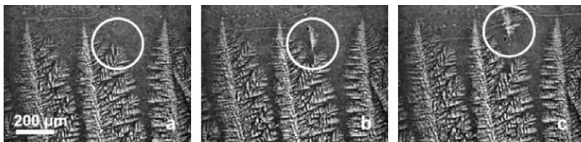
FIGURE I.4 Observation in-situ de la fragmentation de dendrites en présence de convection naturelle, dans un alliage d'Al-20pds%Cu [Ruv07].
