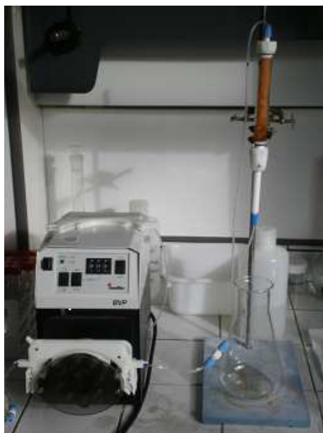
Figure 134 : Photographie du dispositif expérimental pour la régénération des résines
