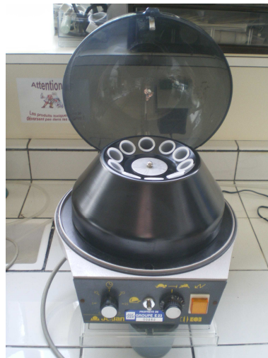
Figure 136 : Photographie du dispositif expérimental pour centrifuger la résine
