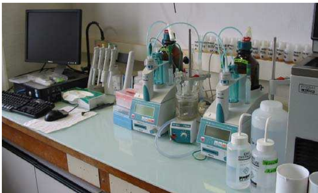
Figure 65: Photographie du système de titration utilisé pour l'étude de la complexation du cuivre.
