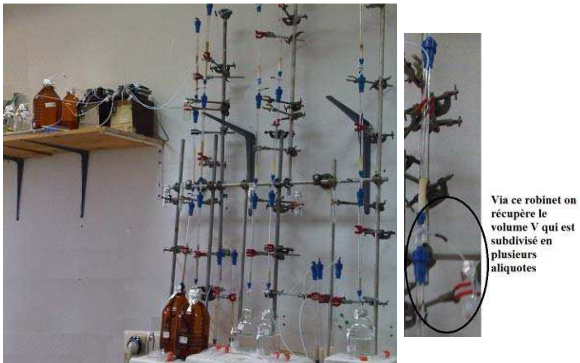
Figure 8: Photo du montage (à gauche), un zoom sur le robinet (à droite).
