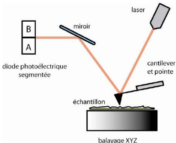
**FIGURE 2.7 – Schéma de principe de la microscopie à force atomique.** La surface de l'échantillon est scannée par une pointe très fine supportée par un micro-levier, dont les déplacements verticaux par rapport à la surface sont restitués par l'intermédiaire d'un faisceau laser dont les mouvements sont enregistrés par un détecteur photoélectrique et permettent de reconstituer la topographie de surface. Tiré de [Saldi \(2009\)](#).
