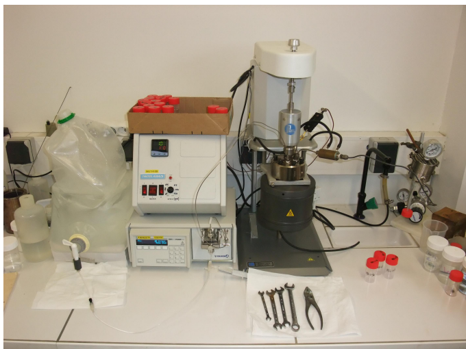
FIGURE 2.5 – Photographie de l'un des réacteurs à circulation de marque Parr® utilisé au cours de cette étude, muni d'une pompe HPLC, d'un régulateur de température et d'un four, d'un système de réfrigération et d'un régulateur de pression.
