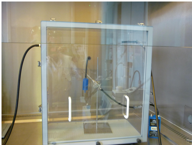
FIGURE 3.1 – Chambre de dispersion en plexiglas.
