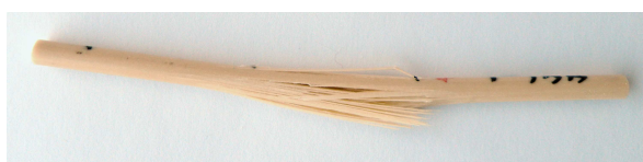
FIG. 1.2.3 – Rupture statique d'un échantillon VD441 sans patins de protection : initiation de la rupture en flexion sous les appuis
