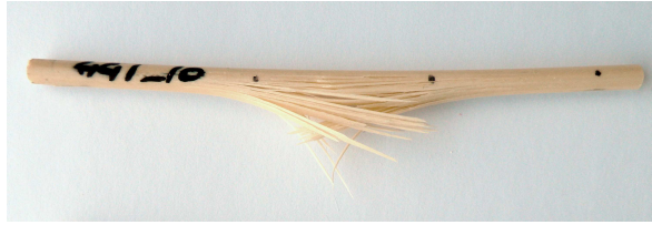
FIG. 1.2.4 – Rupture statique d'un échantillon VD441 avec des patins de protection : initiation de la rupture en flexion au centre de l'échantillon
