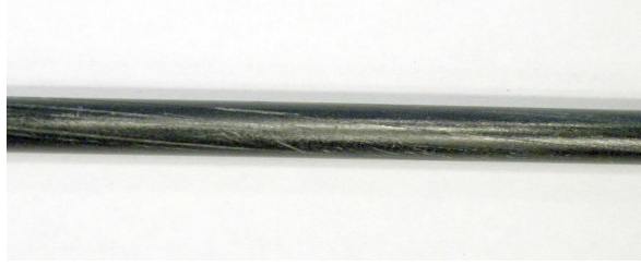
FIG. 1.3.3 – Mode de rupture en torsion pure : fissuration longitudinale
