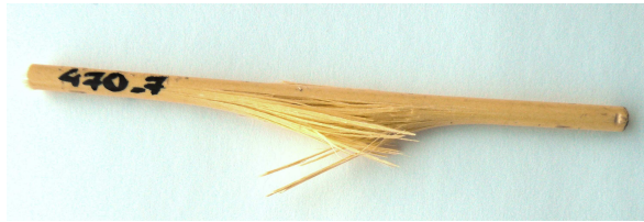
FIG. 1.2.7 – Rupture statique d'un échantillon VD470 avec des patins de protection : rupture en flexion au centre de l'échantillon
