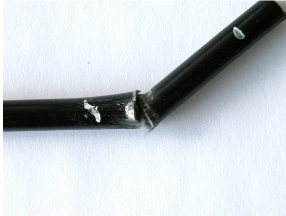
FIG. 1.2.13 – Rupture statique d'un échantillon VA430 sans patins de protection : rupture brutale de l'échantillon par écrasement sous l'un des appuis
