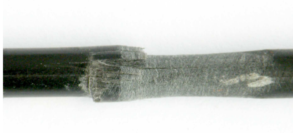
FIG. 1.3.4 – Mode de rupture en compression pure : kink-band
