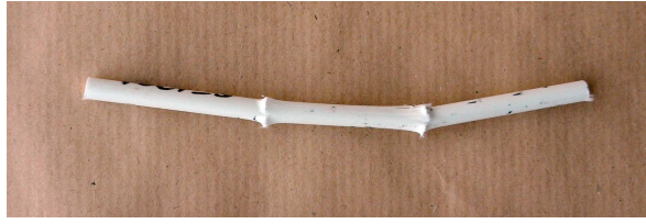
FIG. 1.2.9 – Rupture statique d'un échantillon PDion de 12cm de longueur sans patins de protection : écrasement de l'échantillon sous les appuis
