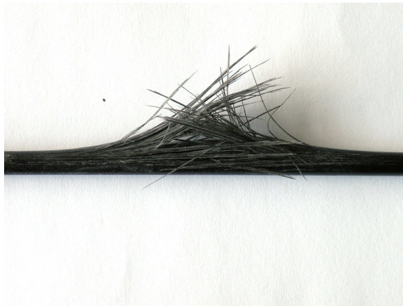
FIG. 1.2.14 – Rupture statique d'un échantillon VA430 avec des patins de protection : rupture progressive "fibreuse" en flexion
