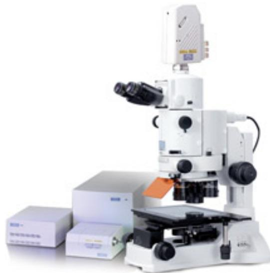
**Figure 1. Macroscope servant aux prises d'images durant les expériences du projet ASTRE (AZ100 NIKON).**
