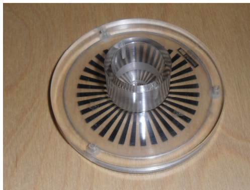
Figure 3. Porte-échantillon contenant la mire centrosymétrique dans lequel on vient placer la cornée face endothéliale vers le haut. Le tout est placé en dessous du microscope.
