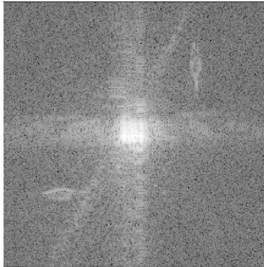
Figure 9. Filtrage spatial autour de la zone contenant le terme associé à l'image réelle. L'image est reconstituée dans un cadre de 512x512 pixels.
