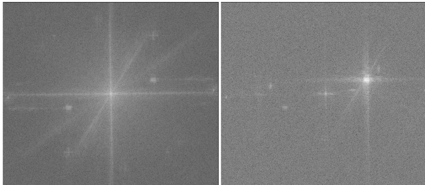
Figure 8. Spectre angulaire correspondant à l'hologramme de la figure 5 (gauche). Spectre angulaire démodulé numériquement à partir de 4 hologrammes déphasés (droite).
