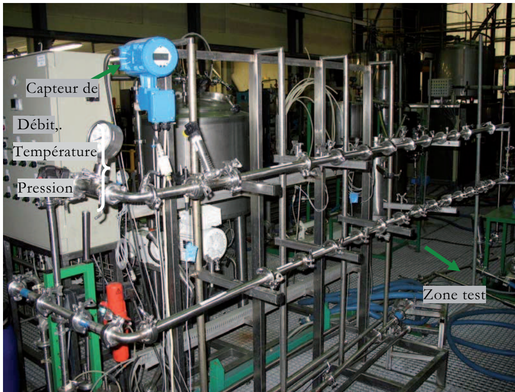
Figure IV. 7 : Photographie de la plate forme expérimentale, les cuves sont situées sous la zone d'expérimentation. La zone test comprenant les tubulures en acier sont visibles.
