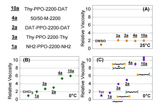
**Figure A.III.1.** Viscosité relative de solutions à 9.6\*10<sup>-2</sup> g/mL de NH<sub>2</sub>-PPO-2200-NH<sub>2</sub> <u>1a</u>, Thy-PPO-2200-Thy <u>3a</u>, DAT-PPO-2200-DAT <u>2a</u>, 50/50-M-2200 <u>4a</u> et Thy-PPO-2200-DAT <u>10a</u>, dans : (A) DMSO à 25°C (à 10% wt), (B) chloroforme à 0°C, and (C) toluène à 0°C.
