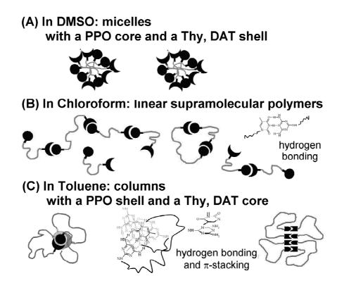
Figure A.III.2. Structuration de Thy-PPO-2200-DAT 10a dans le : (A) DMSO, (B) chloroforme, (C) toluène.
