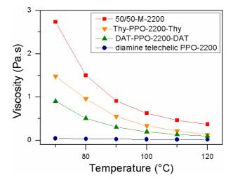
Figure A.III.6. Viscosité en function de la température de PPO-2200 <u>1a</u>, DAT-PPO-2200-DAT <u>2a</u>, Thy-PPO-2200-Thy <u>3a</u>, et 50/50-M-2200 <u>4a</u>.
