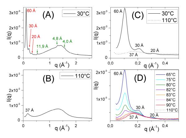
**Figure A.III.3.** Spectres de diffraction des rayons X de Thy-PPO-2200-Thy <u>**3a**</u> à 30°C (A), 110°C (B); élargissement de la zone faible q à 30°C et 110°C (C) et autour de l'ODT ( $T_{ODT} = 85^{\circ}$ C) (D).
