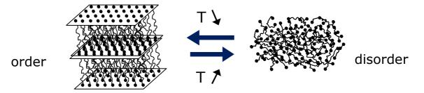
Schéma A.III. 6. ODT: ordre lamellaire et semi-cristallin en-dessous de T<sub>ODT</sub>, désordre au-dessus de T<sub>ODT</sub>.
