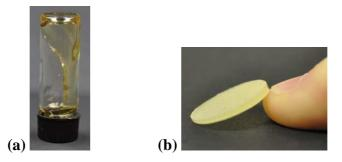
Figure IV.4. Photos de Thy-PPO-2200-Thy  $\underline{3a}$  (a) au-dessus de T<sub>ODT</sub> et (b) en-dessous de T<sub>ODT</sub>.
