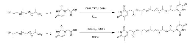
**Schéma A.III.3.** Synthèse de Thy-PPO-X-Thy <u>**3a-c**</u> par amidation de NH<sub>2</sub>-PPO-X-NH<sub>2</sub> <u>**1a-c**</u> par l'acide thymine-1-acétique réalisée (a) en solution avec un agent couplant, ou (b) en masse à 160°C sous azote.
