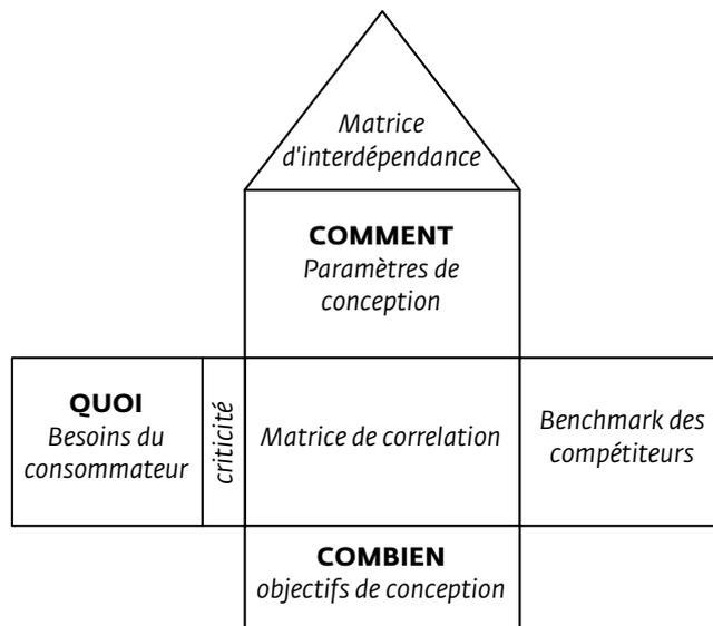
Figure 15 | Principe de l'outil *House of Quality* pour organiser la relation entre les besoins du consommateur et les paramètres de conception de l'objet
