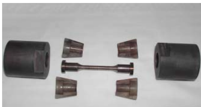
Figure 4-12 : Epreuve de CSC et demi-coquilles isolantes en Zircaloy
