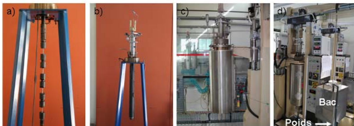
Figure 4-11 : Montage expérimental de CSC a) ligne d'amarrage, b) cylindre permettant la mise en charge, c) autoclave fermé, d) autoclave sur bâti de fluage modifié
