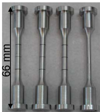
Figure 4-4 : Emplacement des entailles sur le fût de l'éprouvette, 3 éprouvettes entaillées et 1 éprouvette lisse
