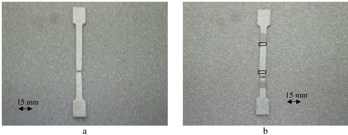
Figure 5-18: a. Éprouvette de métal de base rompue, b. Éprouvette avec cordon de soudure rompue (la ZAT est encadrée en noire sur le Figure 5-18b)
