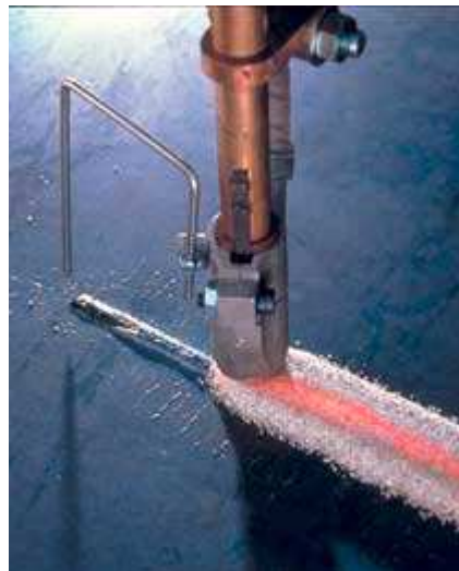
Figure 2-3 : Soudage SAW (sous flux en poudre).
