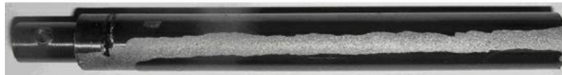
Figure 2-9 : Desquamation partielle de la couche de zircone, gaine oxydée à 1100°C à 18,90% d'ECR et trempée.
