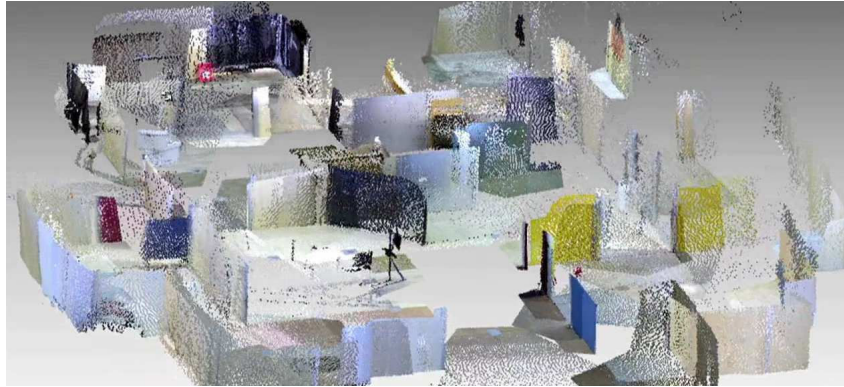
FIGURE 1.6 – Reconstruction d’environnement en 3D avec les algorithmes CoreSLAM, du consortium CoreBots (Concours DGA Carotte 2011).
