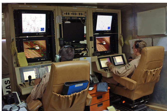
FIGURE 1.3 – Station de contrôle d'un drone Predator (à gauche le pilote du drone, à droite l'opérateur en charge des équipements embarqués). Source US Air Force.
