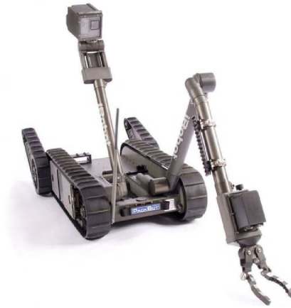
FIGURE 1.5 – Le PackBot, plateforme robotique déclinée pour de multiples tâches : inspection, déminage, exploration d’environnements hostiles (centrales nucléaires...). Source iRobot.
