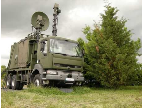
FIGURE 1.4 – Station de liaison de données pour drone Sperwer. Source Sagem.
