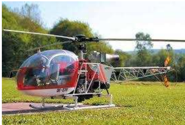
Figure 24– Hélicoptère Alouette II motorisé par un Astazou
