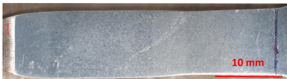
Figure 4-37 : macrographie de la surface de l'éprouvette de traction provenant de l'essai à 20°C.
