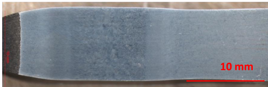
Figure 4-44 : macrographie de la surface de l'éprouvette de traction provenant de l'essai à 20°C.
