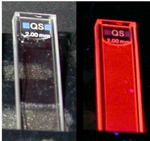
**Figure 1 : Solution colloïdale de nanoparticules d'YVO<sub>4</sub>:Eu. La transparence de celle-ci est mise en évidence à la lumière ambiante (gauche). La couleur rouge typique du dopage europium est visible sous illumination UV à 265 nm (droite).**
