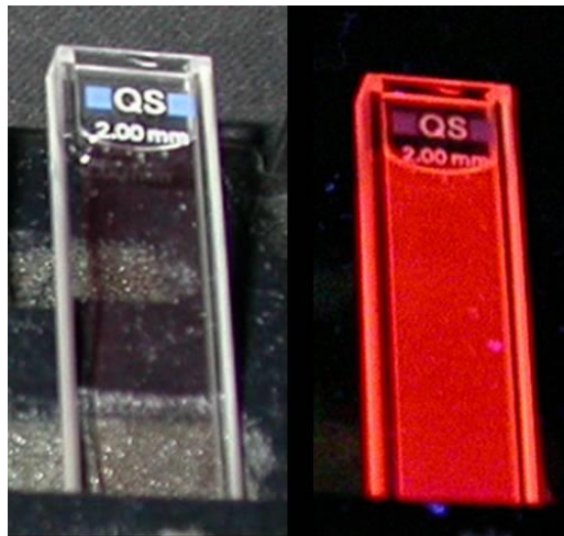
Figure 1 : Solution colloïdale de nanoparticules d'YVO 4 :Eu. La transparence de celle-ci est mise en évidence à la lumière ambiante (gauche). La couleur rouge typique du dopage europium est visible sous illumination UV à 265 nm (droite).
