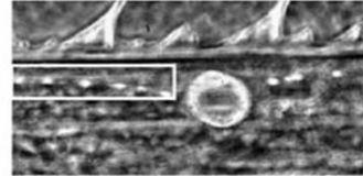
(b) Formation de gouttes dans une jonction en T : la phase dispersée est une solution diluée de POE (fluide viscoélastique), et la phase continue est une huile silicone (fluide newtonien)
