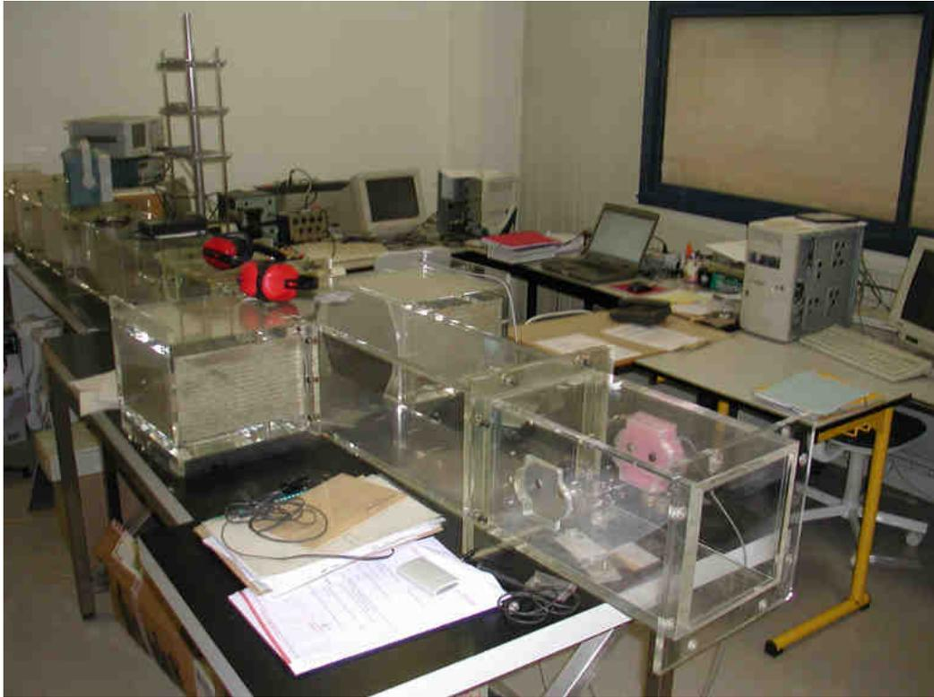
FIG. 8.2 – Vue réelle de la maquette du guide d’ondes expérimental.
