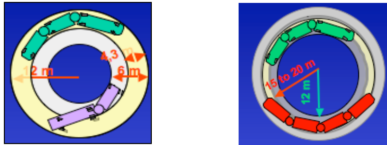
Figure 53: Comparaison des rayons de giration de l'autobus articulé et du tramway sur pneu (Source: STRV, STMAC, Autorité Organisatrice du Transport de Caen)
