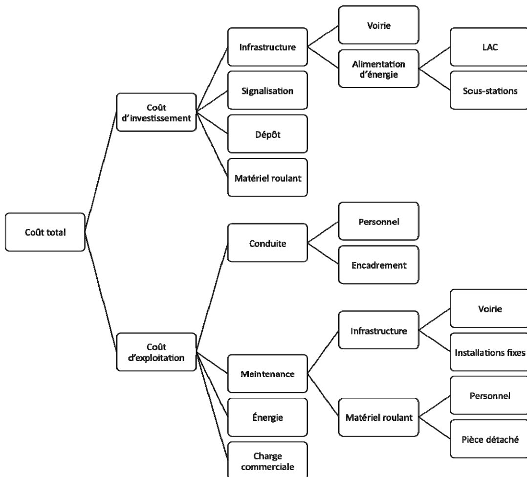
Figure 79: Structure des coûts d'un tramway (Source : auteur)
