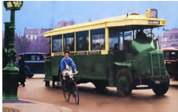
Figure 16 : L'autobus type TN 6 du réseau de la STCRP puis de la RATP (Source : http://www.planeterenault.com/histoire2-28-Le+Bus+TN6.html )
