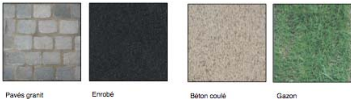
Figure 27: Exemples des revêtements utilisés en France (Source: RATP)
