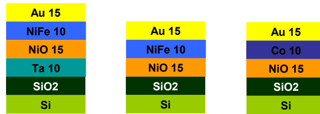
FIGURE 2.22 – Empilements magnétiques élaborés pour l'étude des propriétés du couplage d'échange avec NiO (épaisseurs exprimées en nm).
