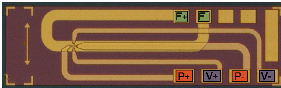
FIGURE 3.22 – Puce magnétorésistive à effet Hall plan de l'instrument ADM. On y distingue la zone active du capteur (en forme de croix) ainsi que les circuits électriques de polarisation (en rouge), de mesure (en bleu) et de contre-réaction (en vert).
