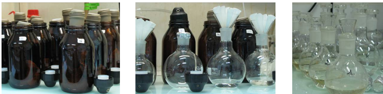
Figure 16 : remplissage des bombes, filtration sur filtres plissés après extraction et récupération dans des ballons (Gilbert, 2011)
