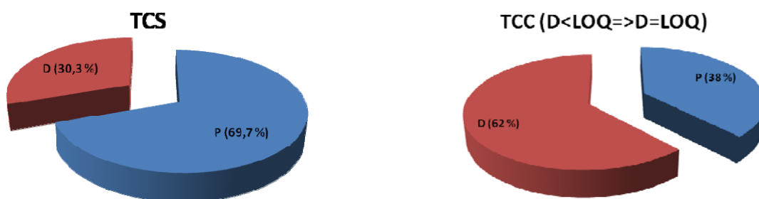
Figure 34 : Répartition du triclosan et du triclocarban entre les phases dissoutes et particulaires (en % de D+P), valeur moyenne sur l’ensemble des échantillons
