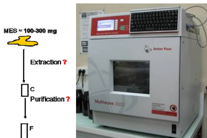
Figure 15 : Extraction de la phase particulaire des parabènes, du TCS et du TCC sur Multiwave 3000
