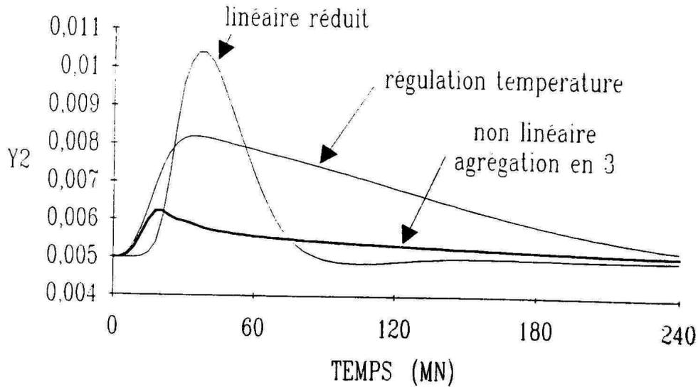
Figure 3.16: dépropaniseur ; réponse à une variation de composition d'alimentation ; comparaison d'une commande externe, d'une cascade composition/température et de la commande sur le modèle en 3 compartiments ; mesures parfaites.
