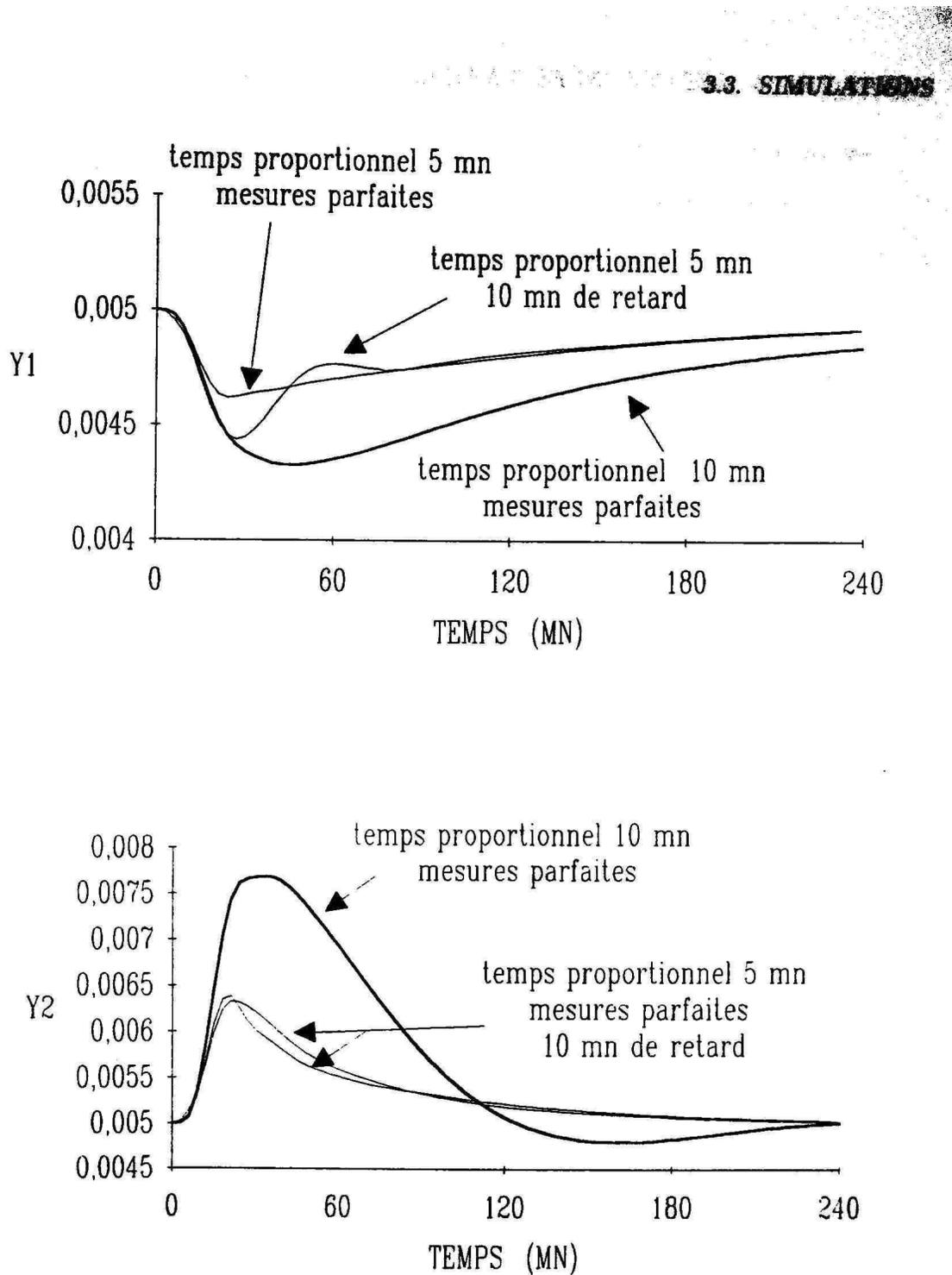
Figure 3.12: dépropaniseur ; réponse à une variation de composition d'alimentation ; influence d'une diminution des paramètres de réglages  $\tau_1^P$  et  $\tau_2^P$  sur la loi de commande sur le modèle en 5 compartiments.
