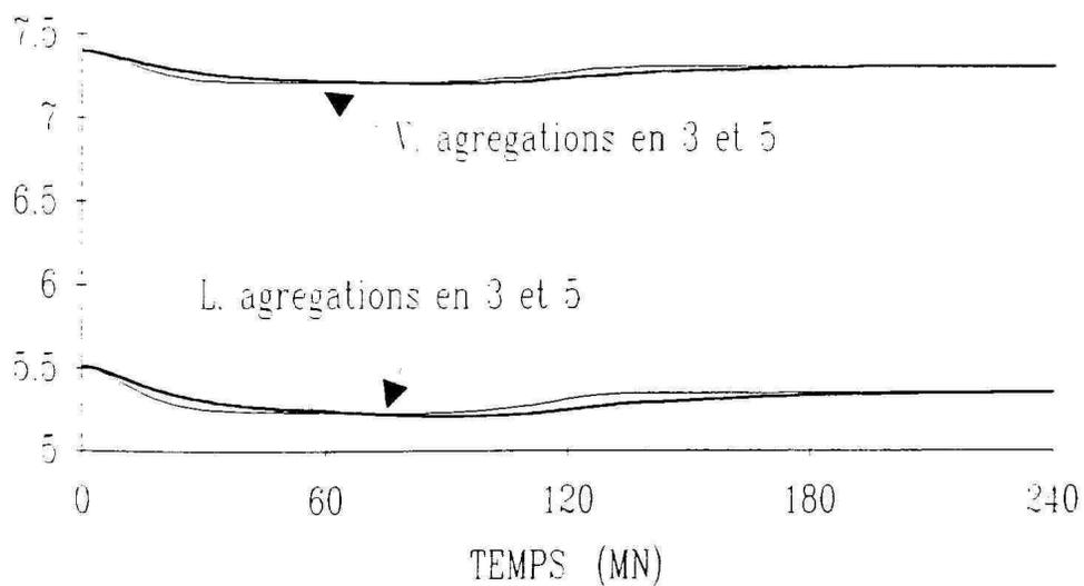
Figure 3.11: dépropaniseur; changement de la consigne de tête; commandes calculées sur les modèles agrégés en 3 et 5 compartiments; retard de 10 mn dans les mesures des sorties.
