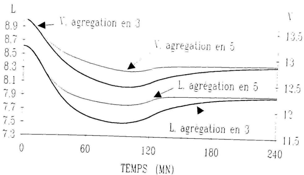
Figure 4.5: débutaniseur ; changement de la consigne en fond ; commandes calculées sur les modèles agrégés en 3 et 5 compartiments ; pas de retard dans les mesures des sorties.
