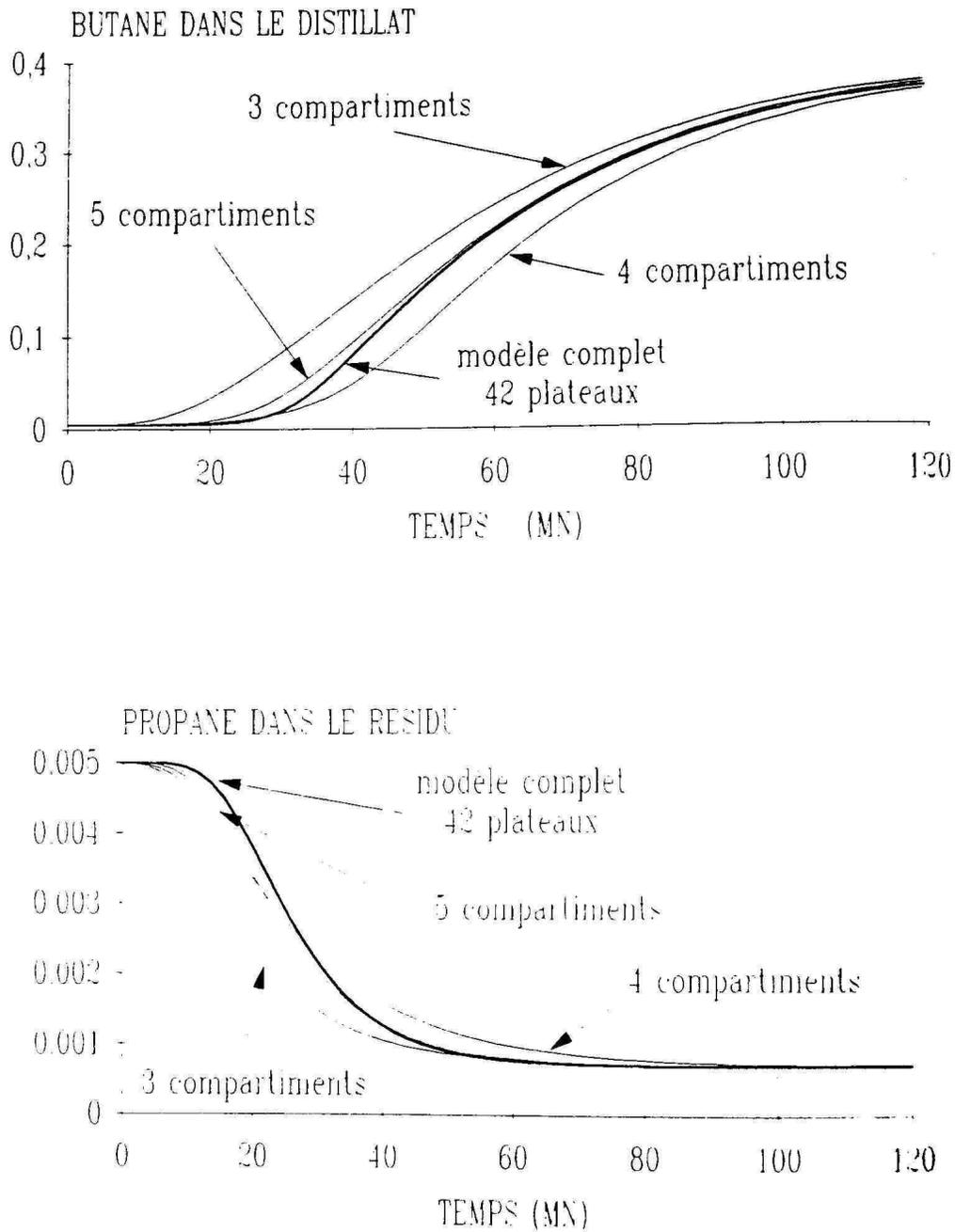
Figure 3.4: comparaison de modèles agrégés en 5, 4 et 3 compartiments; dépropaniseur de 42 plateaux; variation de composition de l'alimentation.
