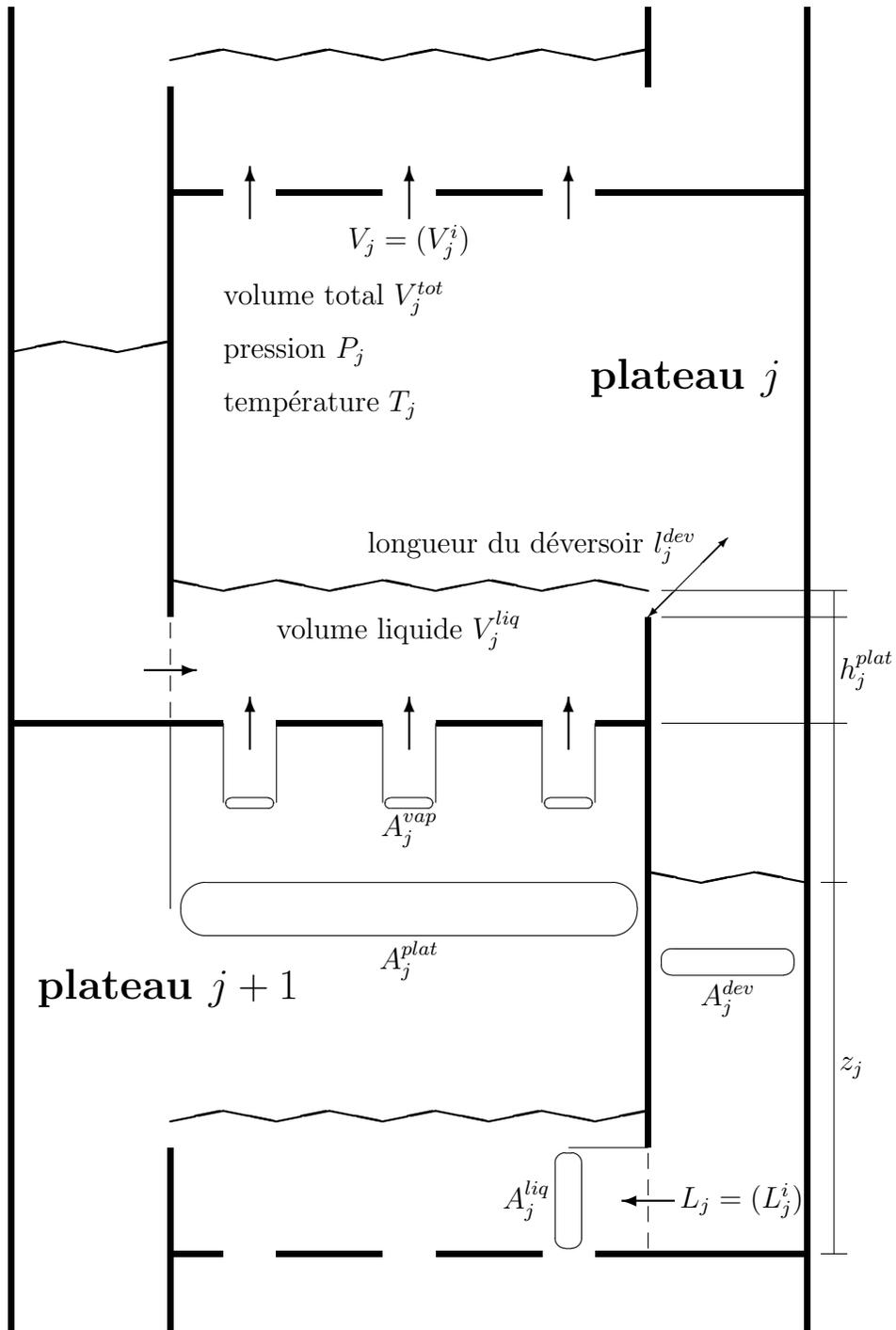
Figure 1.1: un plateau type de colonne à distiller.
