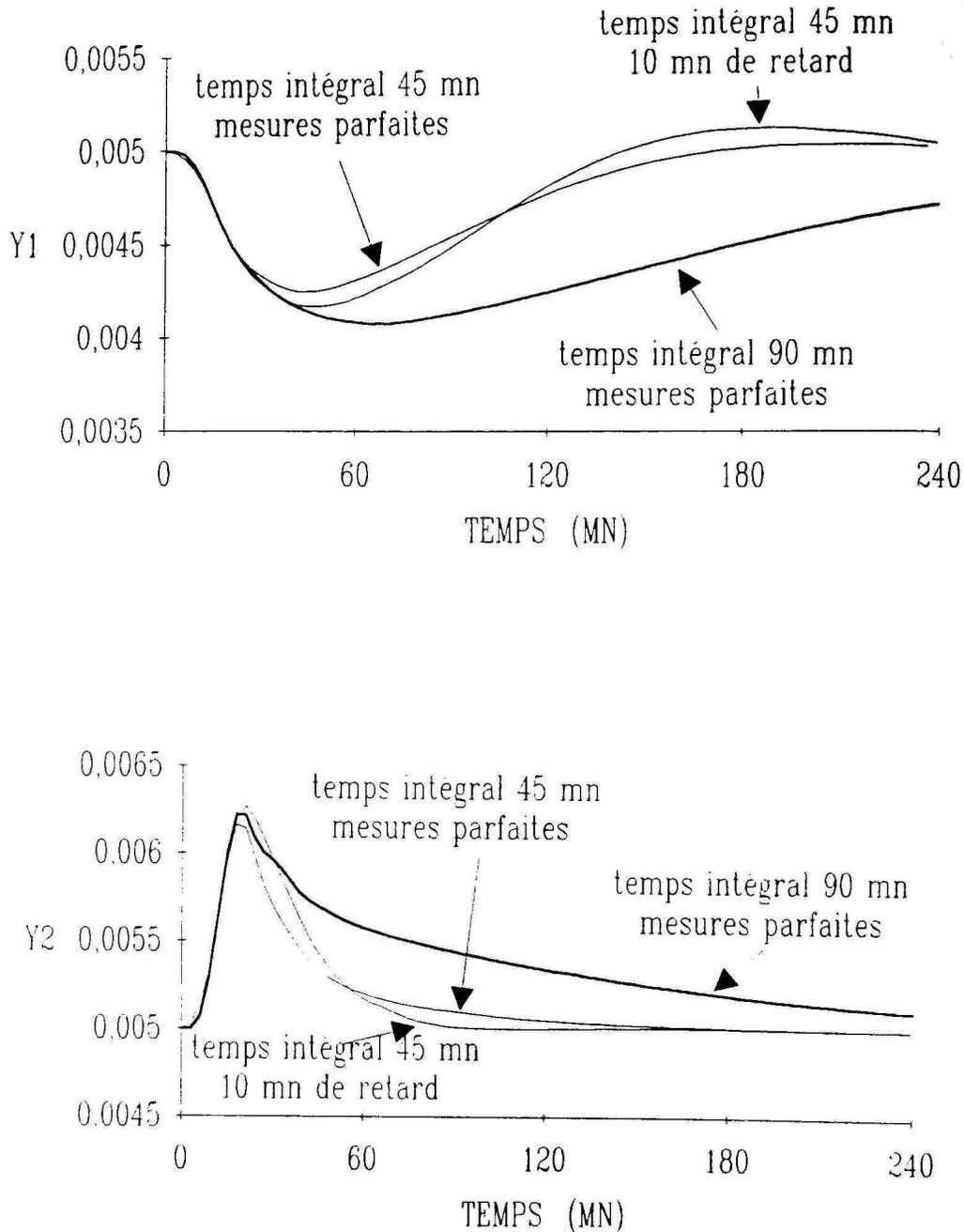
Figure 3.13: dépropaniseur ; réponse à une variation de composition d'alimentation ; influence d'une diminution des paramètres de réglages  $\tau_1^I$  et  $\tau_2^I$  sur la loi de commande sur le modèle en 3 compartiments.
