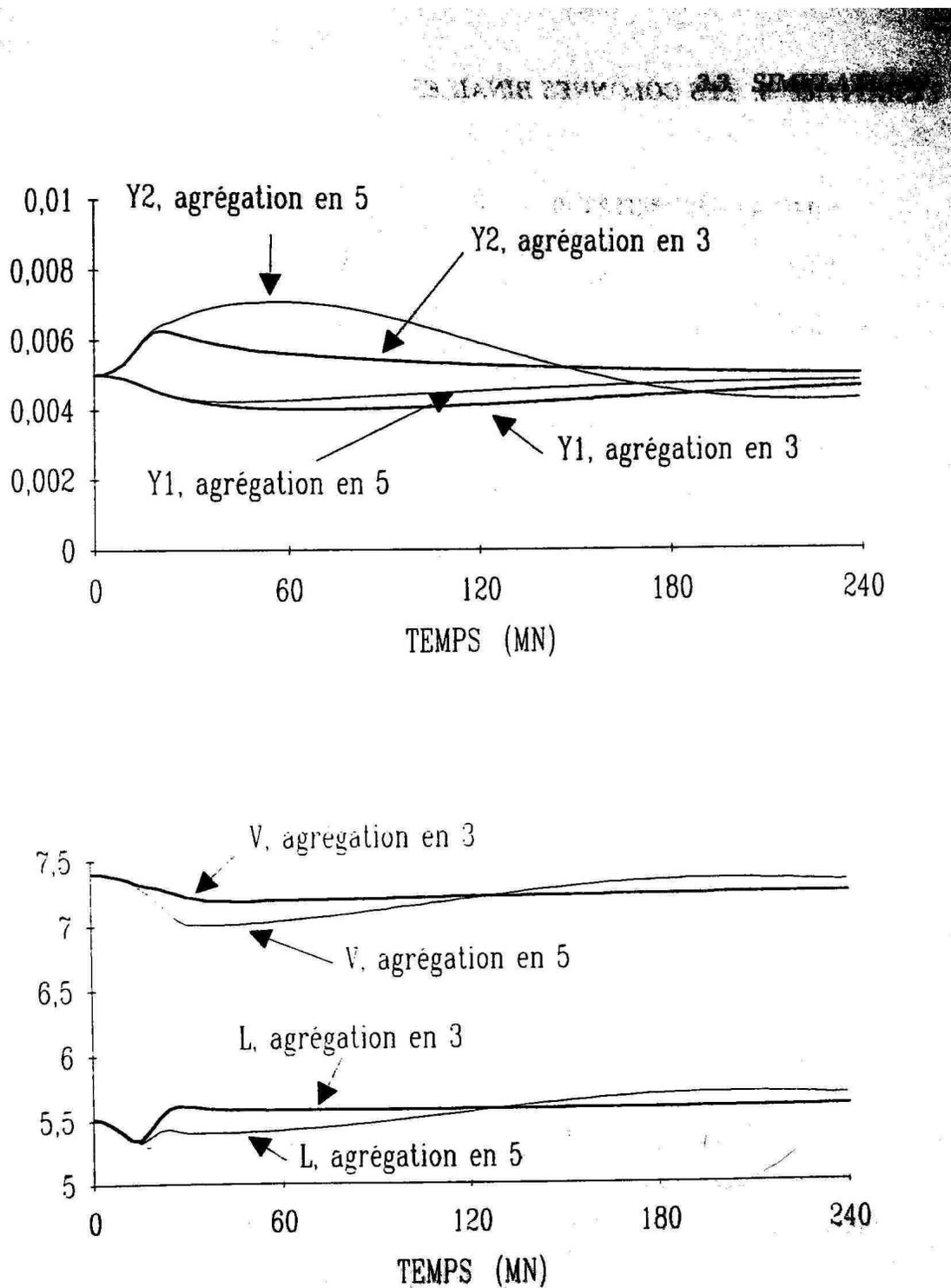
Figure 3.9: dépropaniseur ; réponse à une perturbation de composition de l'alimentation ; commandes calculées sur les modèles agrégés en 3 et 5 compartiments ; retard de 10 mn dans les mesures des sorties.
