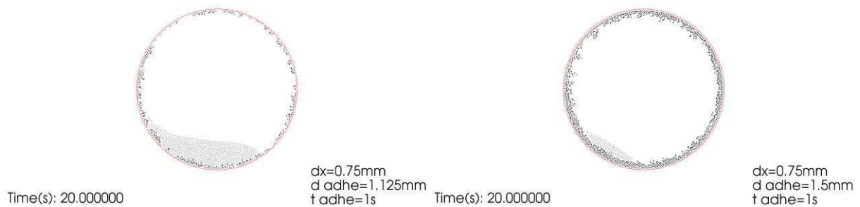
Figure 72 : Influence de d_{adhe} sur le processus d'adhésion pour dx=0,75mm . Le moule est représenté en rouge, le fluide en gris et la matière adhéree en noir.
