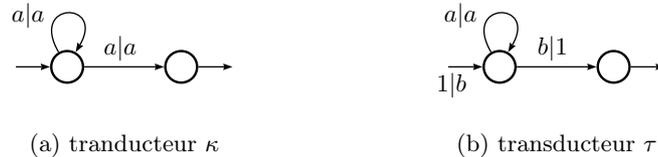
FIGURE 8.12 – Transducteurs pour lesquels la construction est sans fin
