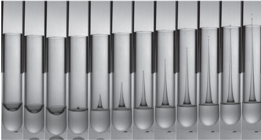
FIGURE 3.8 – Formation d’un jet lors de l’accélération d’une surface courbée, tiré de [44].
