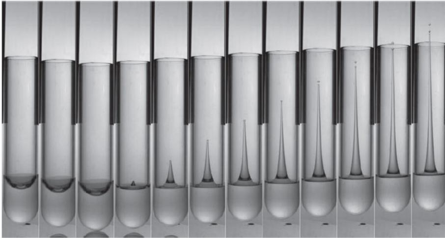
FIGURE 3.8 – Formation d’un jet lors de l’accélération d’une surface courbée, tiré de [44].
