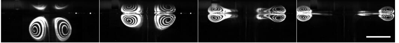
FIGURE 5.8 – Chronophotographie d'un anneau tourbillonnaire de circulation 60 \text{ cm}^2/\text{s} et d'un diamètre initial de 2.5 \text{ cm} arrivant sur une surface libre d'éthanol. La partie supérieure des images est la réflexion dans la surface, et permet de déduire la position de celle-ci. Les images sont séparées de 80 \text{ ms} , la ligne blanche fait 2 \text{ cm} de long.
