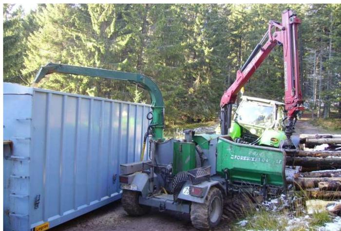
Figure 67 : Chantier de production de plaquettes forestières par *FBV Energie Bois*
