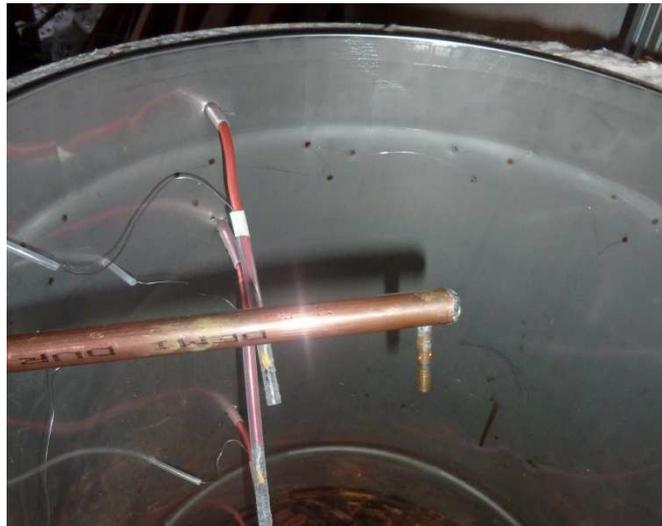
**Figure 72 : Prise de pression statique**
