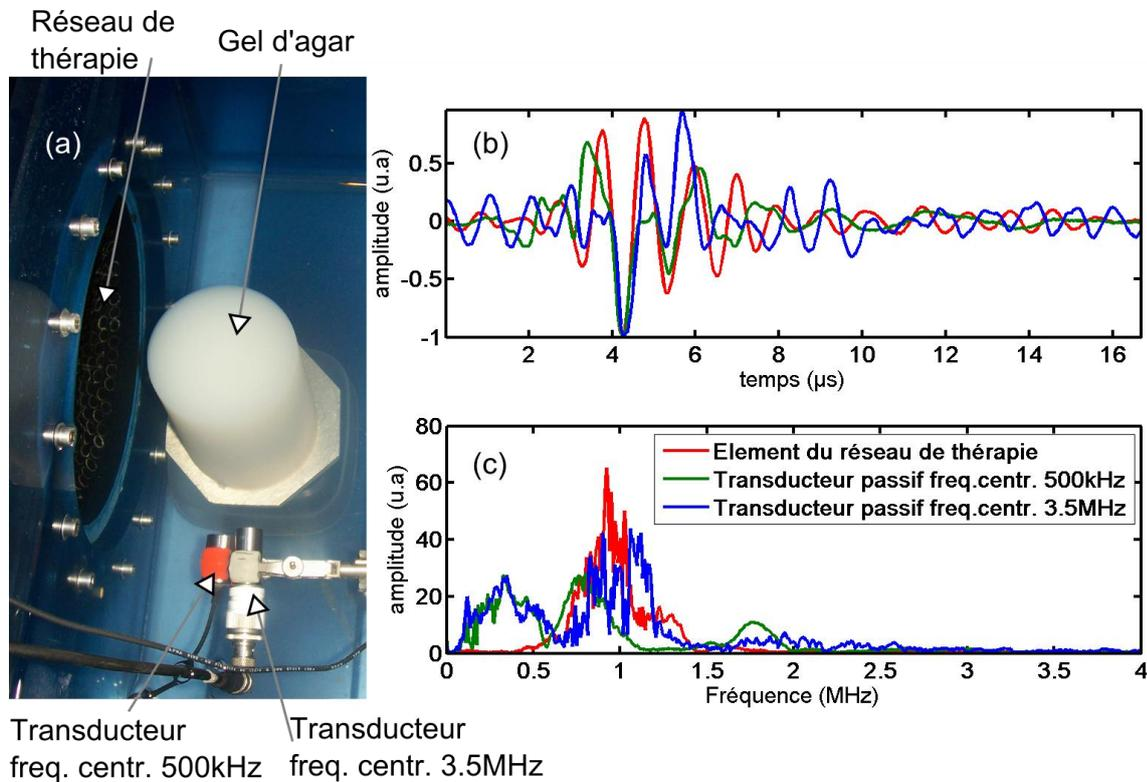
**Figure II-6** Détection passive, en absence de crâne, impliquant deux transducteurs (de fréquence centrale respective 500kHz et 3.5MHz) en plus du réseau. (a) diapositif expérimental, (b) signaux temporels captés sur chacun des détecteurs, (c) module de la transformée de Fourier
