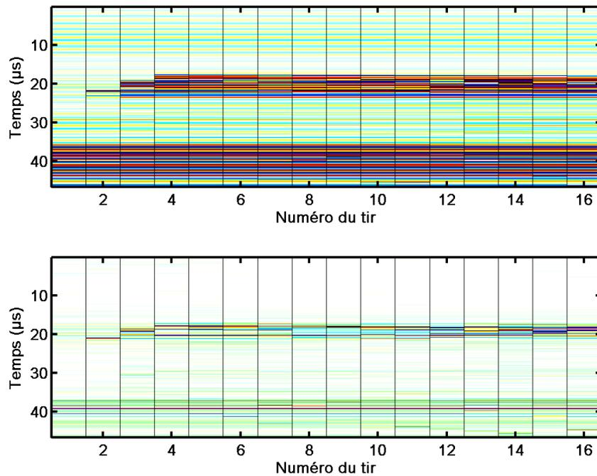
**Figure IV-24** Signaux RF passifs collectés sur la voie de réception 32 du réseau de détection. Les signaux sur la ligne supérieure ne sont pas filtrés, pour ceux présentés sur la ligne du bas un filtrage passe haut est effectué (FIR, Butterworth d'ordre 3, fréquence de coupure 3MHz).
