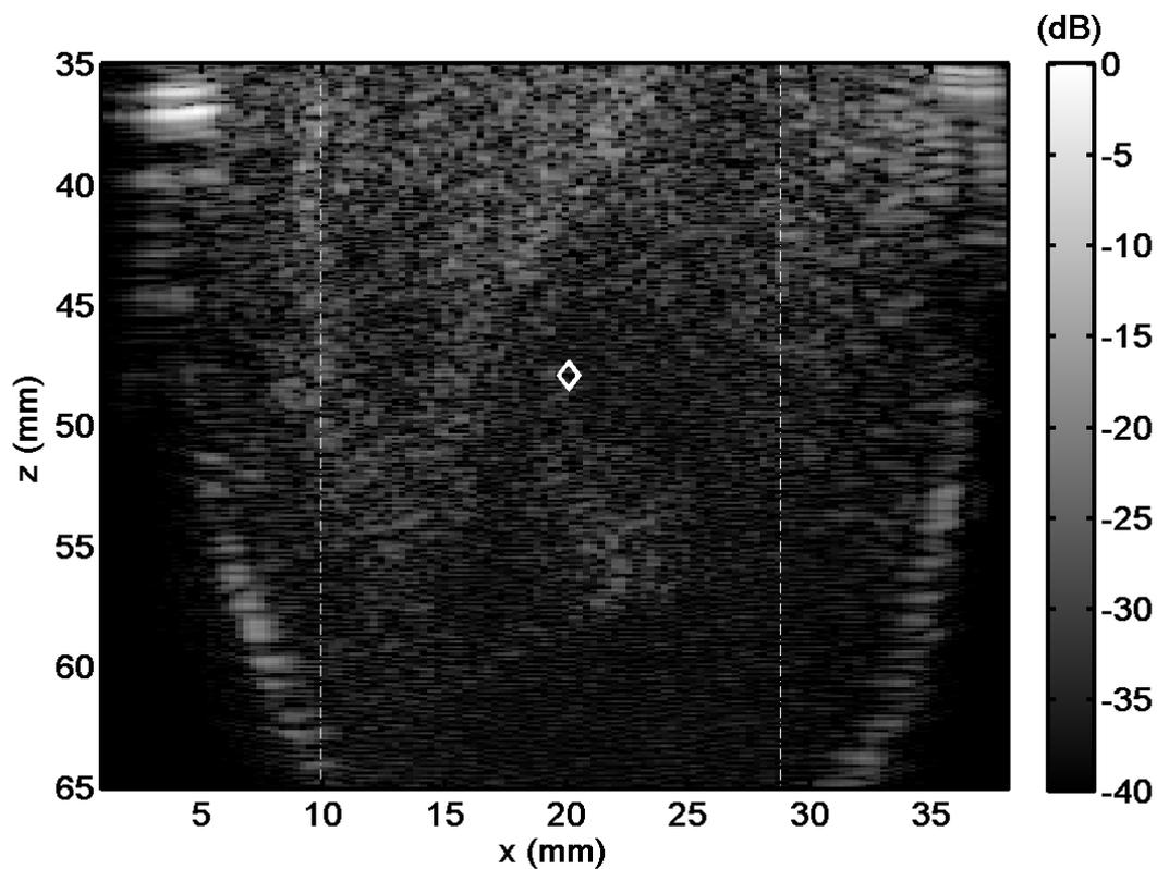
*Figure IV-2 B-mode standard réalisé avec le réseau du système 2. La détection de bulle est réalisée entre les deux lignes pointillées blanches verticales. Le point focal du monoélément du système 2 est marqué par un losange blanc et permet un ciblage.*
