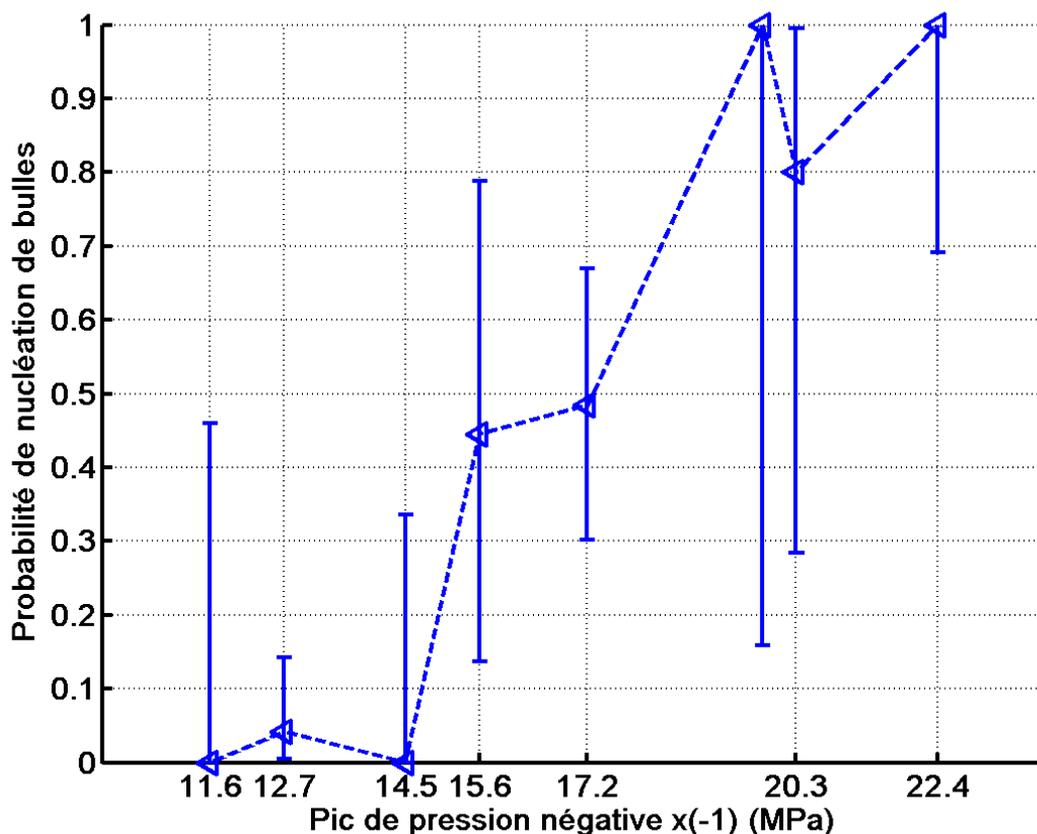
*Figure IV-15 Probabilité de nucléation de bulles en fonction du pic de pression négative au point focal. L'estimation de la probabilité de nucléation est indiquée par un marqueur. Les barres d'erreurs symbolisent les intervalles de confiance à 95%.*
