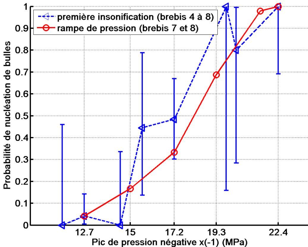
*Figure IV-17 Comparaison des estimations de probabilité de nucléation de bulles réalisées pour des premières insonifications (événements indépendants, Figure IV-15), et à partir des données issues des acquisitions utilisant des rampes de pression.*
