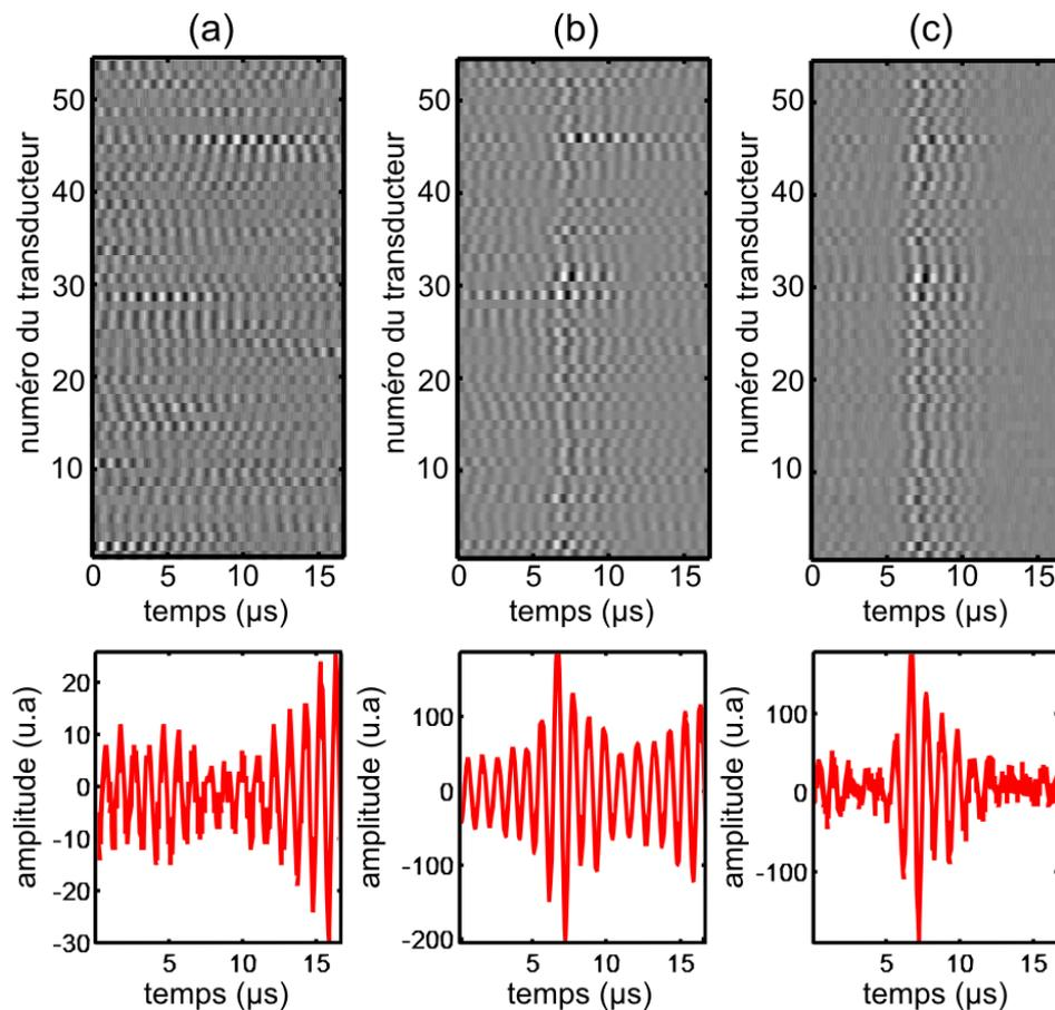
**Figure II-5** Signaux de détection passive à travers le crâne pour : une excitation basse amplitude (a), à amplitude maximale (b). La différence après correction d'amplitude (c). Les signaux sont présentés au dessus pour les 54 éléments du réseau pouvant recevoir en échelle de gris. L'échelle est adaptée à chaque sous-figure. Au dessous pour le transducteur numéro 23 en particulier.
