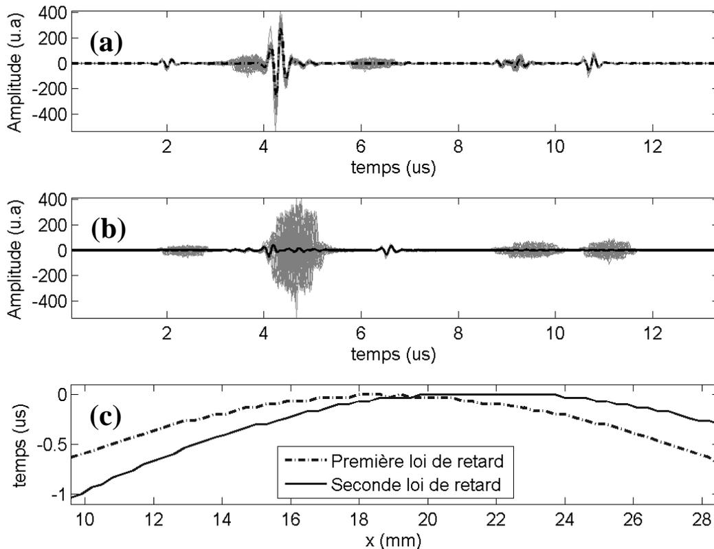
**Figure III-15 (Gel de gélatine 1) Alignement des signaux passifs radio-fréquences (RF) filtrés pour le premier tir. (a) et (b) montrent l'alignement des RF correspondant respectivement à la première et à la seconde loi de retard tracées sur (c). Pour (a) et (b) les courbes grises superposées sont les 64 signaux passifs reçus sur les éléments du réseau et retardés suivant la loi de retard considérée, et la ligne noire plus large correspond à leur moyenne.**
