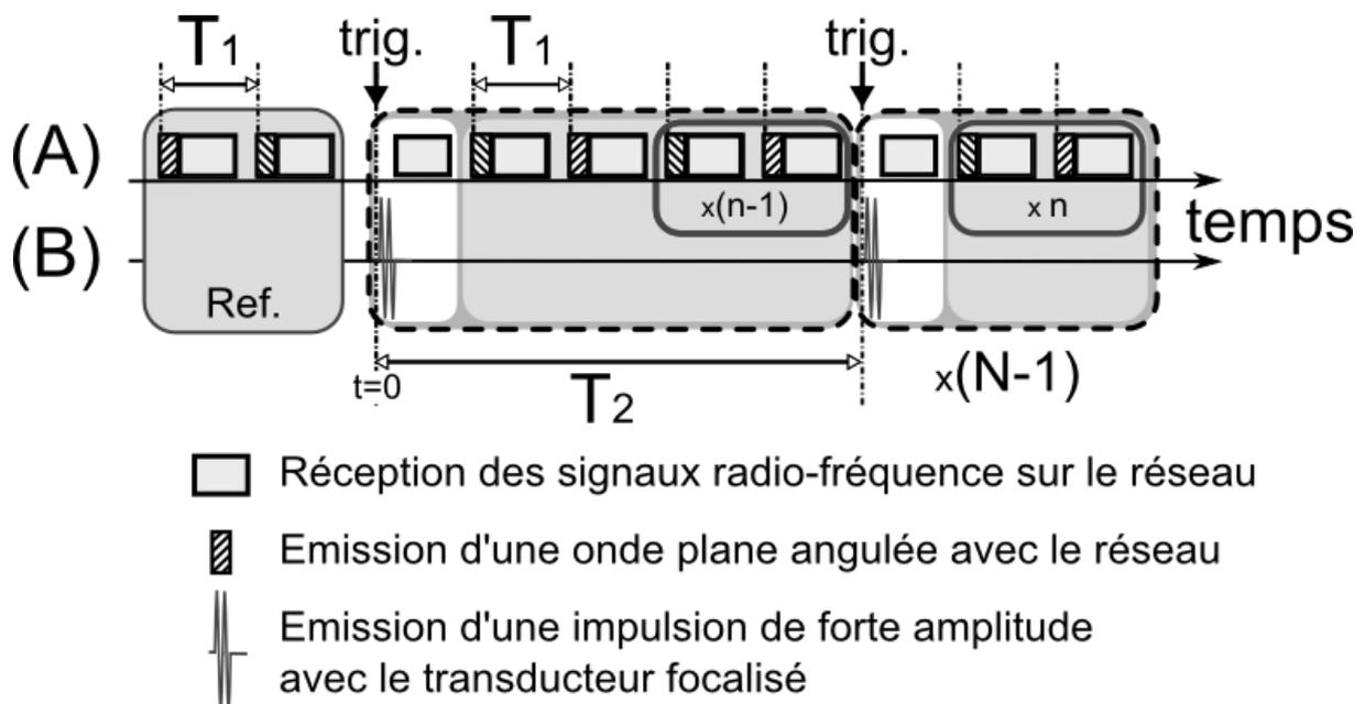
**Figure III-10** Séquence de détection combinant la détection passive et active. Les deux axes temporels représentent la chronologie des événements pour (A) l'échographe programmable en émission et réception, et (B) la voie électronique haute puissance du mono-élément focalisé. La synchronisation des deux chronologies s'effectue à  $t=0$ . Le signal de déclenchement (trigger) est envoyé par l'échographe et permet de synchroniser l'excitation de forte amplitude et l'écoute passive.
