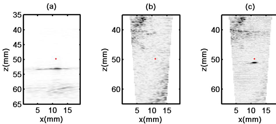
**Figure IV-21** Images passive et actives à l'issue du troisième tir. (a) présente l'image passive obtenue à partir des données filtrées. (b) et (c) représentent la seconde image active après l'excitation de forte amplitude (soit 786 $\mu$ s après tir). (b) est l'image active sans soustraction de la référence et (c) est l'image ADC correspondante. La position du point focal est indiquée par un losange rouge.
