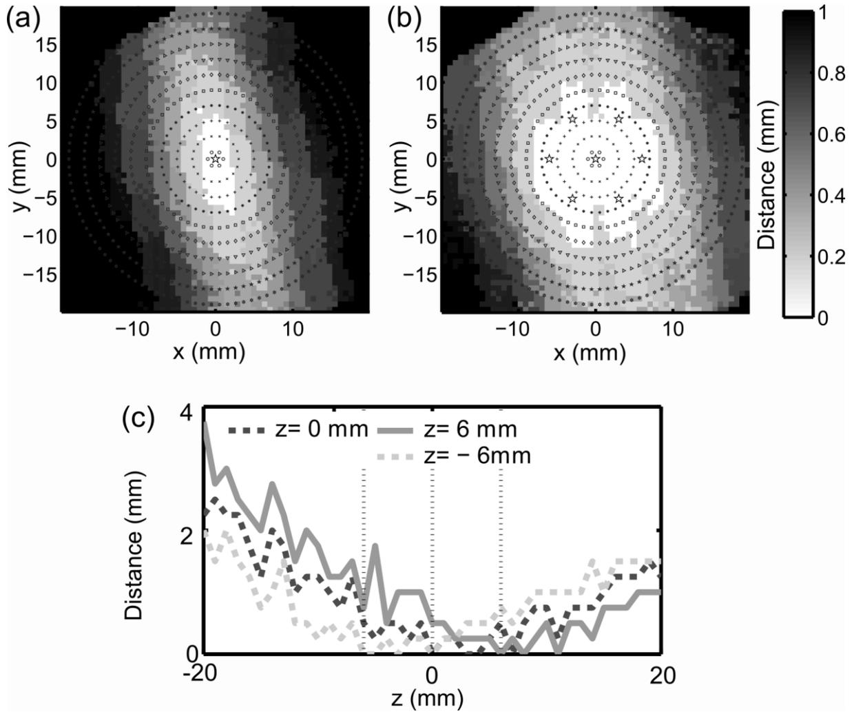
**Figure II-12** *Distribution de l'erreur faite, avec l'angulation électronique, sur la position du point focal : (a) dans le plan focal et lorsque le foyer géométrique est la seule position de référence utilisée, (b) dans le plan focal et lorsque sept positions de référence sont utilisées, (c) suivant l'axe de la sonde pour trois positions de référence. L'erreur est exprimée en terme de distance à la position ciblée.*
