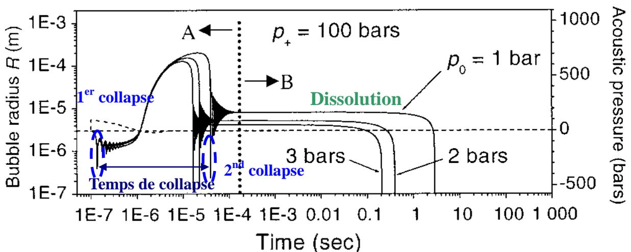
**Figure III-17** (issue de [III-15]) Evolution du rayon d'une bulle, selon le modèle de Church, pour un tir de lithotripsie de pression positive de 10Mpa (forme d'onde en pointillé). Le rayon initial de la bulle est de  $3\mu\text{m}$ . Dans leur étude, Sapozhnikov et al font varier la pression statique  $p_0$  d'où les différentes courbes.
