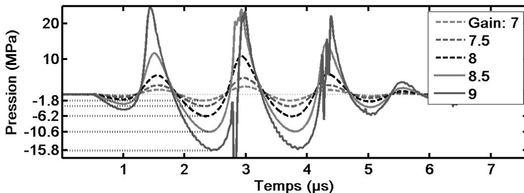
*Figure IV-3 Formes d'onde utilisées pour insonifier les échantillons de sang (mesure dans l'eau). Elles sont obtenues au point focal de l'élément de thérapie du système 2 et avec l'amplificateur 5kW pour une excitation de 2 cycles avec une polarisation positive. Les formes d'onde résultent de la moyenne sur 15 acquisitions successives. Les valeurs des pics de pression négative sont données en ordonnée.*
