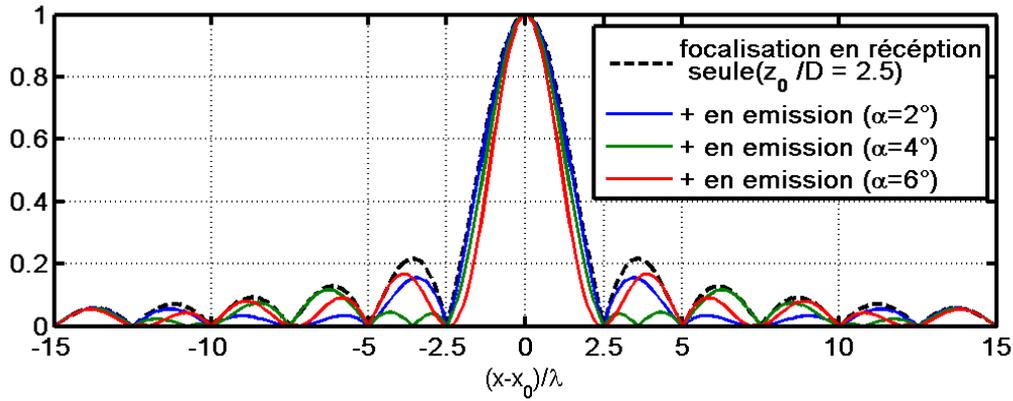
Figure III-7. Dépendance en  $x$  (dimension latérale) de l'amplitude de la tâche focale dans le cas de deux illuminations d'angles opposés ( $\alpha$ ). Pour la focalisation en réception, on choisit une ouverture relative :  $z_0/D=2.5$ , ce qui correspond à un diffuseur ponctuel situé au niveau du point focal pour le système 2.
