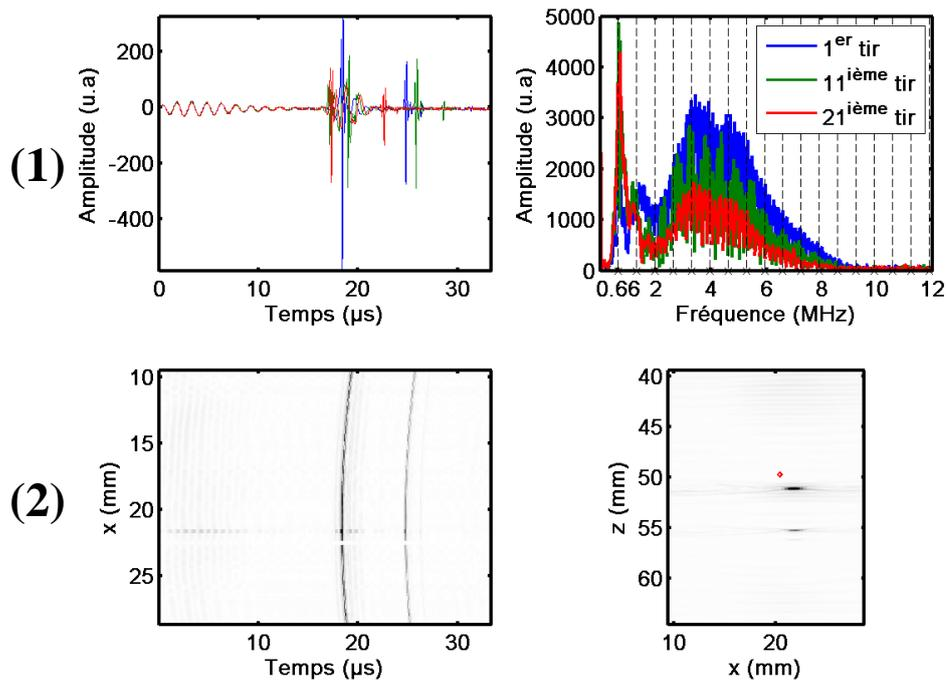
**Figure IV-4** Données passives correspondant à une acquisition pour laquelle des bulles ont nucléées dans le milieu dès le premier tir. (1) présente les signaux radiofréquences bruts enregistrés sur le 65<sup>ième</sup> traducteur du réseau et l'amplitude de la transformée de Fourier correspondant pour les tirs numéro : 1, 11 et 21. (2) Bscan passif (à gauche) et image passive synchronisée (à droite) pour le premier tir
