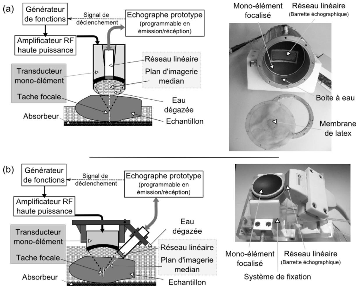
**Figure III-1** Schémas et photos des systèmes confocaux (a) Système 1 (mono-élément focalisé de fréquence centrale : 2.25MHz), (b) Système 2 (mono-élément focalisé de fréquence centrale : 660kHz).
