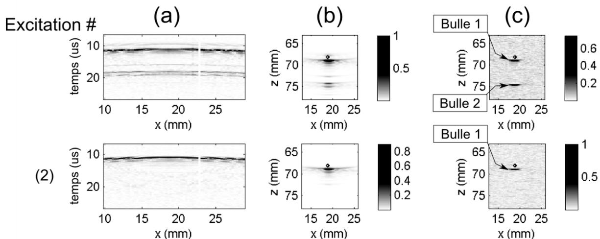
**Figure III-20 (Gel de gélatine 2) Données de détections liées aux différentes excitations. (a) Bscan passif et (b) image passive synchronisée pour les données filtrées passe haut (FIR, Butterworth d'ordre 3,  $f_c=3\text{MHz}$ ). (c) seconde image ADC après chaque excitation. Pour (b) et (c) la position du point focal est indiquée par un losange noir. Les amplitudes des images sont normalisées par rapport au maximum de la série.**
