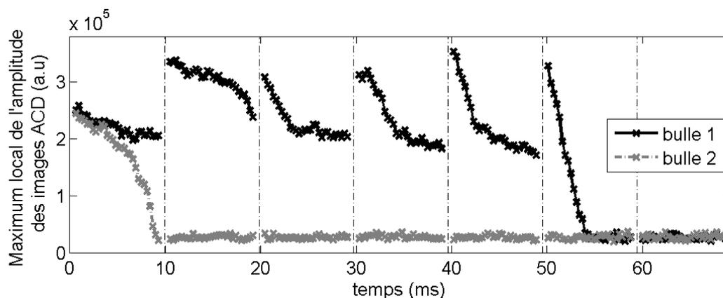
**Figure III-21 (Gel de gélatine 2) Evolution de l'amplitude de diffusion des bulles identifiées sur la Figure III-20 et après les sept premiers tirs. Les tirs de forte amplitude sont indiqués par les traits verticaux.**
