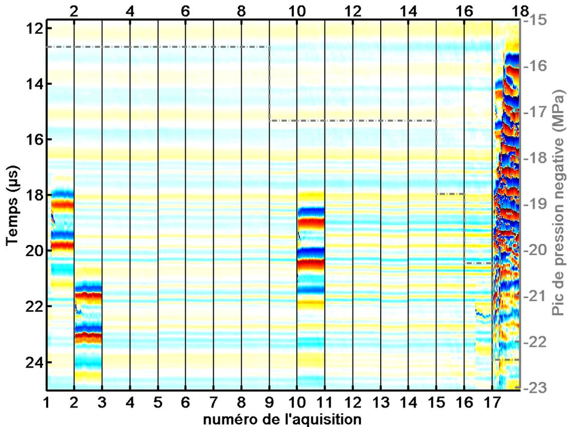
*Figure IV-30 Signaux RF passif collectés sur la voie de réception 32 du réseau de détection. Les signaux ne sont pas filtrés, mais on choisit d'afficher une fenêtre temporelle comportant uniquement les premiers signaux de bulle. La ligne en escalier grise correspond à la valeur du pic de pression négative au foyer du monoélément de thérapie pour chaque acquisition.*
