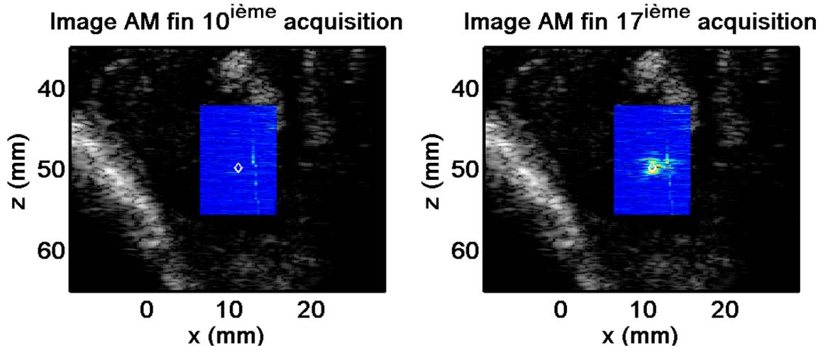
*Figure IV-32 Superposition de l'image B-mode et d'une image de modulation d'amplitude (AM) acquise après le 35<sup>ème</sup> tir pour les acquisitions 10 et 17. Les images AM sont renormalisées par rapport au maximum des deux. La ligne présente sur l'image AM après la 10<sup>ème</sup> acquisition est dû à du bruit électronique, on la retrouve sur l'image AM après la 17<sup>ème</sup> acquisition.*
