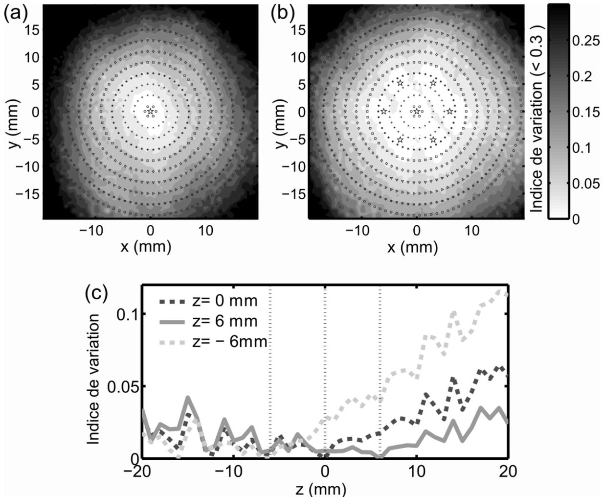
**Figure II-11** Distribution de l'indice de variation : (a) dans le plan focal et lorsque le foyer géométrique est la seule position de référence utilisée, (b) dans le plan focal et lorsque sept positions de référence sont utilisées, (c) suivant l'axe de la sonde pour trois positions de référence. Les positions de référence sont indiquées sur (a) et (b) par une étoile à 5 branches, et pour (c) par une ligne pointillée verticale.
