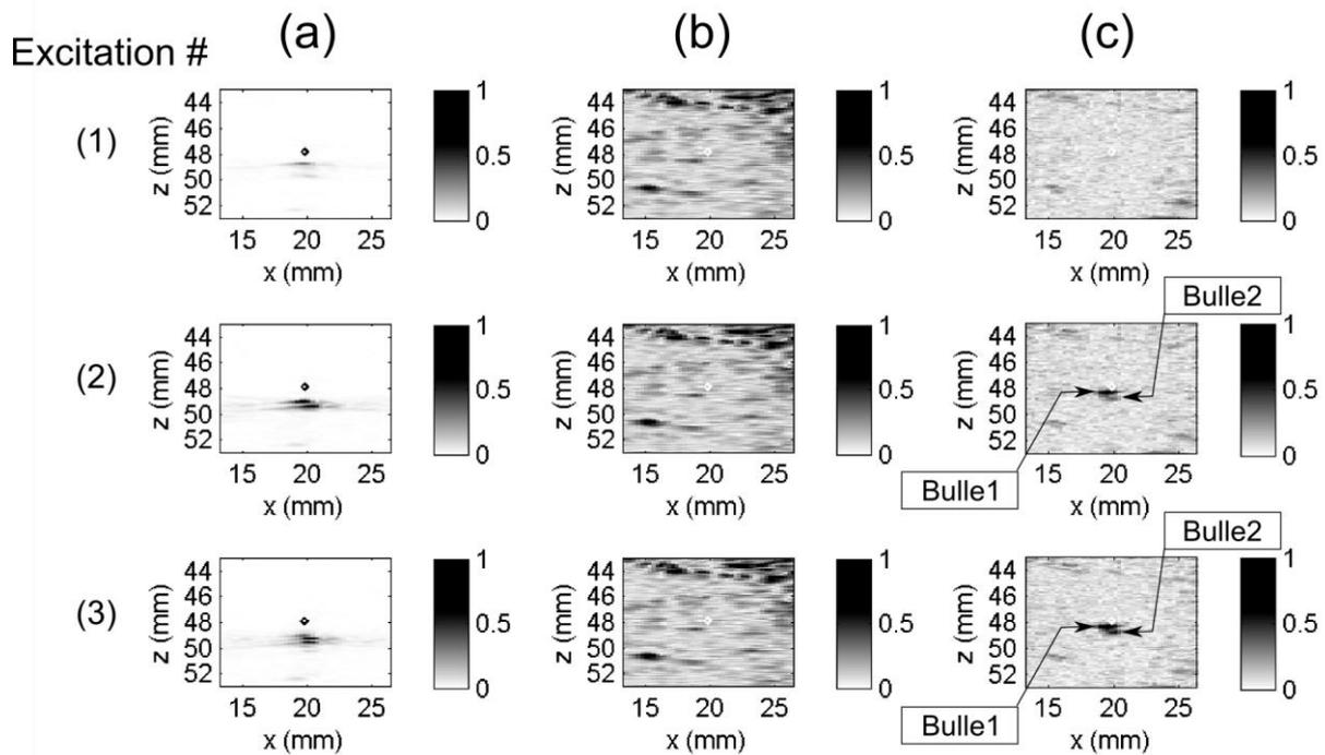
**Figure III-24 (Morceau de muscle 1) Images de détections liées aux différentes excitations. (a) image passive synchronisée pour les données filtrées passe haut (FIR, Butterworth, ordre 3,  $f_c=3\text{MHz}$ ). (b) seconde image active sans soustraction de la référence et (c) image ADC correspondante après chaque excitation. La position du point focal est indiquée par un losange noir ou blanc. Les amplitudes des images sont normalisées par rapport au maximum de la série.**
