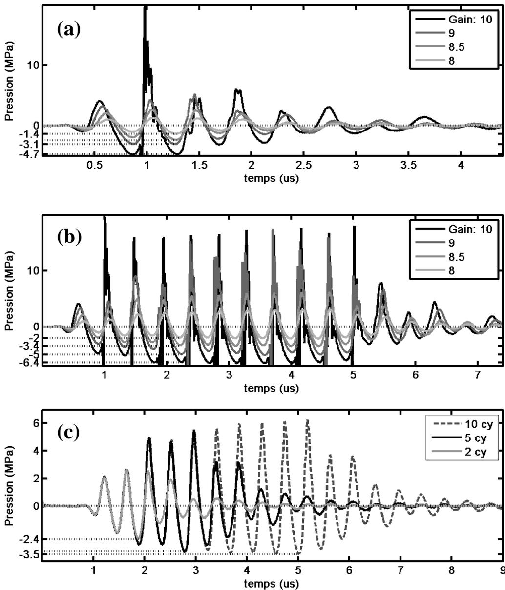
**Figure III-2 Pressions accessibles avec l'élément de thérapie du système 1 et l'amplificateur 5kW pour une excitation de (a) 2 cycles, (b) 10 cycles. (c) la comparaison entre des signaux d'excitation de 2, 5 et 10 cycles pour un gain de 8.5. Les formes d'onde résultent de la moyenne sur 15 acquisitions successives. Les valeurs des pics de pression négative sont données en ordonnée.**
