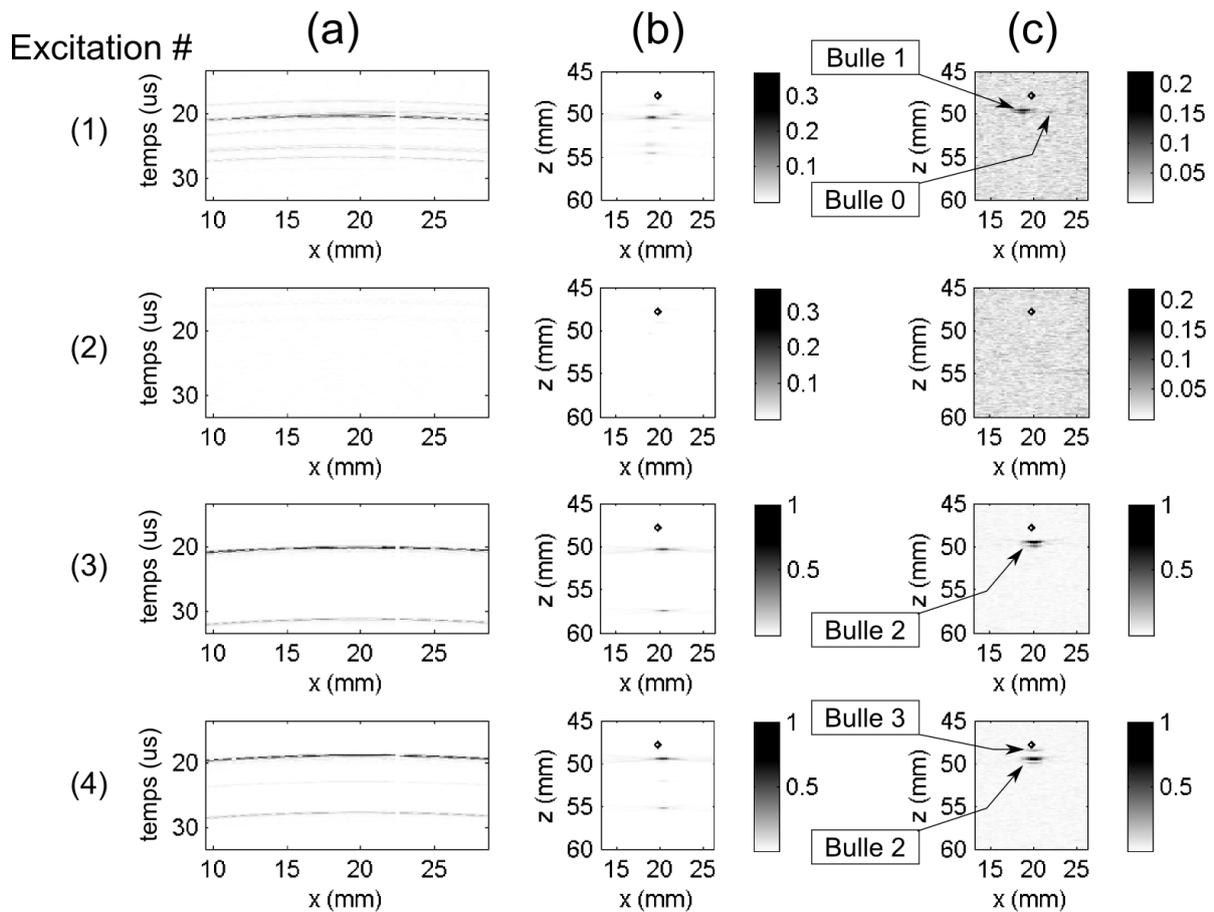
**Figure III-12 (Gel de gélatine 1) Données de détections liées aux différentes excitations. (a) Bscan passif et (b) image passive synchronisée pour les données filtrées passe haut. (c) seconde image ADC après chaque excitation. Pour (b) et (c) la position du point focal est indiquée par un losange noir. Les amplitudes des images sont normalisées par rapport au maximum de la série.**
