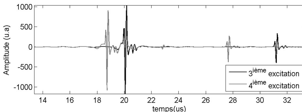
**Figure III-18 (Gel de gélatine 1) Signaux radiofréquence non filtrés enregistrés pour le troisième et le quatrième tir sur le 65<sup>ème</sup> élément du réseau.**
