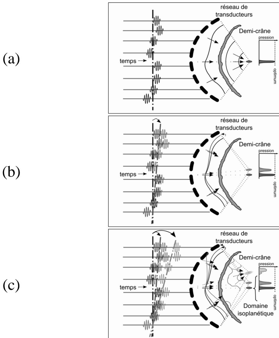
**Figure II-9 Principe de l'angulation électronique de faisceaux ultrasonore à travers le crâne, schématisé ici pour des positions ciblées situées dans le plan focal de la sonde. A partir d'une correction d'aberration optimale (a), les lois de focalisation pour deux autres positions sont déduites par simple décalage temporel (b) et (c). La focalisation se dégrade à mesure que l'on s'éloigne de la position de référence (a). Le concept de domaine isoplanétique est illustré sur (c)**
