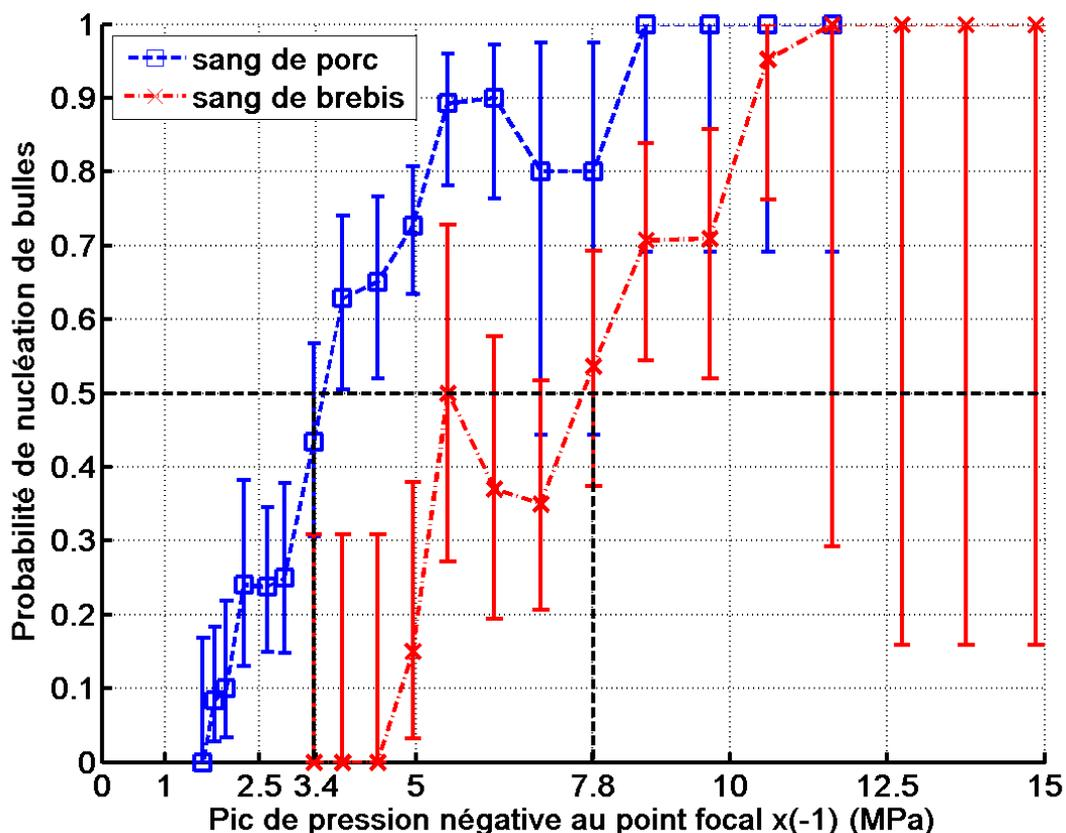
*Figure IV-7. Probabilité de nucléation de bulles en fonction du pic de pression négative au point focal. L'estimation de la probabilité de nucléation est indiquée par un marqueur. Les barres d'erreurs symbolisent les intervalles de confiance à 95%. Au total, 779 acquisitions ont été réalisées pour le sang de porc, et 282 acquisitions pour le sang de brebis.*
