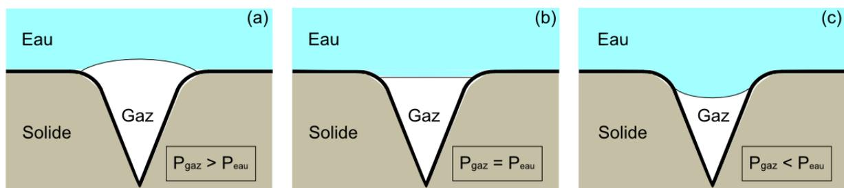
**Figure I-1. Mécanisme de stabilisation d'une poche de gaz dans une crevasse de type cône inversé. Le rayon de courbure de l'interface eau-gaz peut s'ajuster suivant le rapport des pressions : (a) le rayon est positif, (b) le rayon est infini, (c) le rayon est négatif.**
