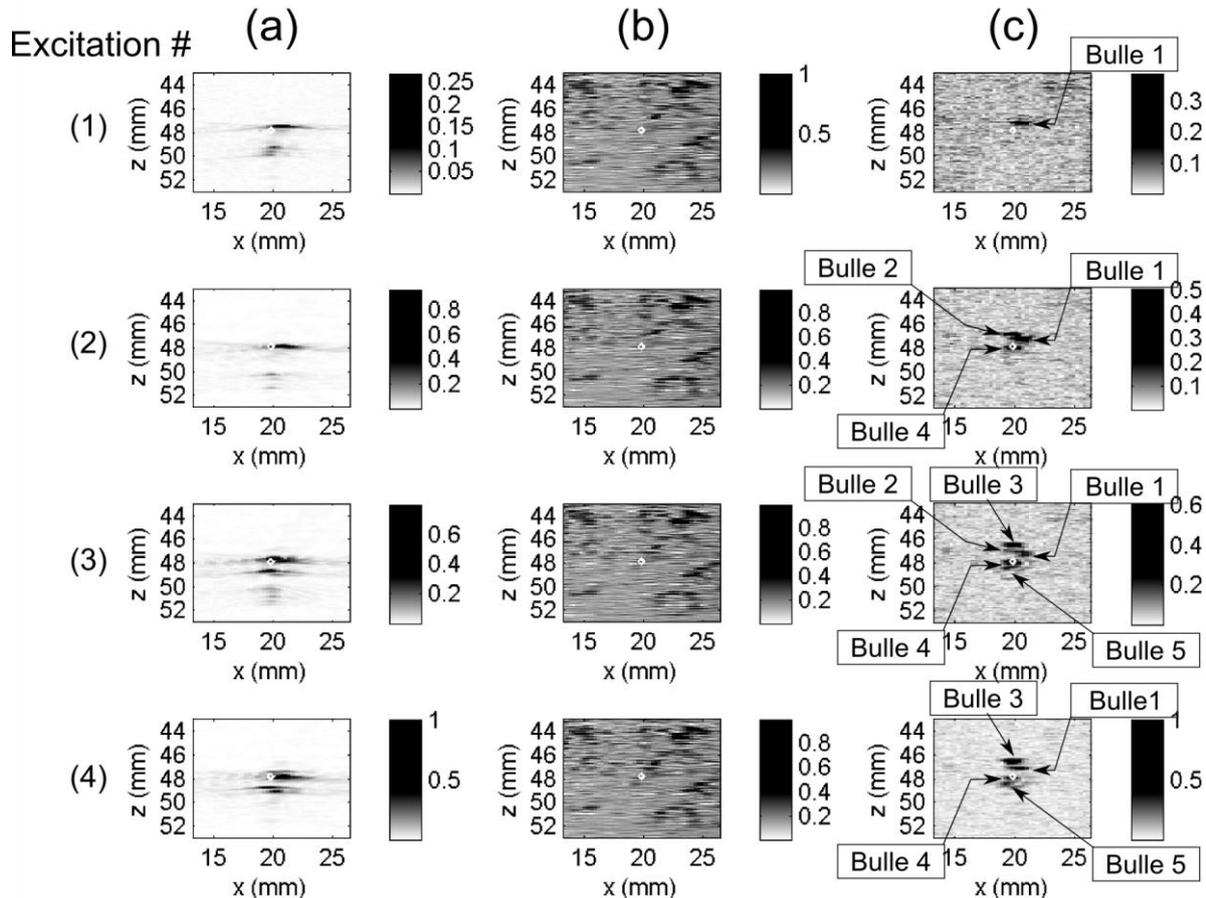
**Figure III-26 (Morceau de muscle 2) Images de détections liées aux différentes excitations. (a) image passive synchronisée pour les données filtrées passe haut (FIR, Butterworth, ordre 3,  $f_c=3\text{MHz}$ ). (b) seconde image active sans soustraction de la référence et (c) image ADC correspondante après chaque excitation. La position du point focal est indiquée par un losange blanc. Les amplitudes des images sont normalisées par rapport au maximum de la série.**
