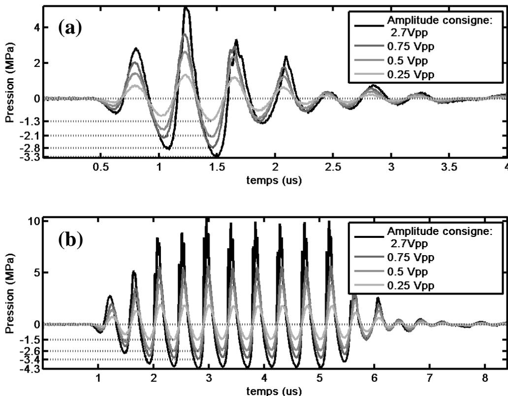
**Figure III-3 Pressions accessibles avec l'élément de thérapie du système 1 et l'amplificateur 300W pour une excitation de (a) 2 cycles, (b) 10 cycles. Les formes d'onde résultent de la moyenne sur 15 acquisitions successives. Les valeurs des pics de pression négative sont données en ordonnée.**
