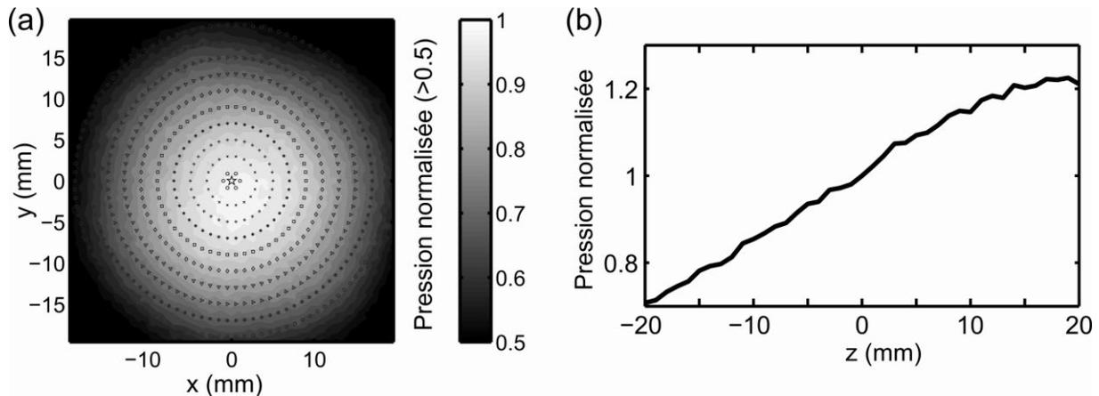
**Figure II-10** Distribution de la pression optimale accessible : (a) dans le plan focal, (b) suivant l'axe de la sonde. Les valeurs de pression sont normalisées par rapport à la pression optimale accessible au foyer géométrique du réseau. Pour (a), la position du foyer géométrique est indiquée par une étoile à 5 branches, et est aussi le centre des cercles de repérage (premier à 1mm de rayon, puis incrément de 2mm de rayon pour les suivants)
