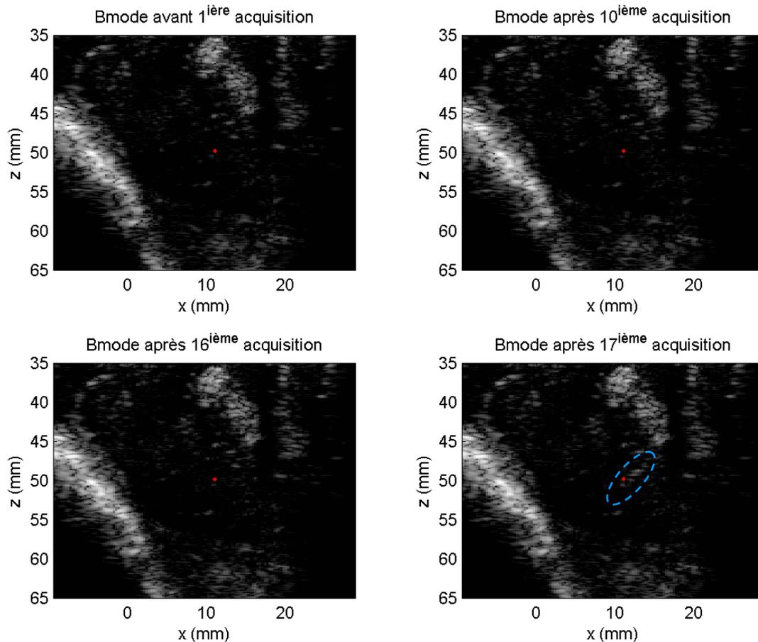
**Figure IV-31 Images B-mode du milieu à différents instants. Après la 17<sup>ième</sup> acquisition une zone hyperéchogène nouvelle est visible sur l'image B-mode (entourée en bleu)**
