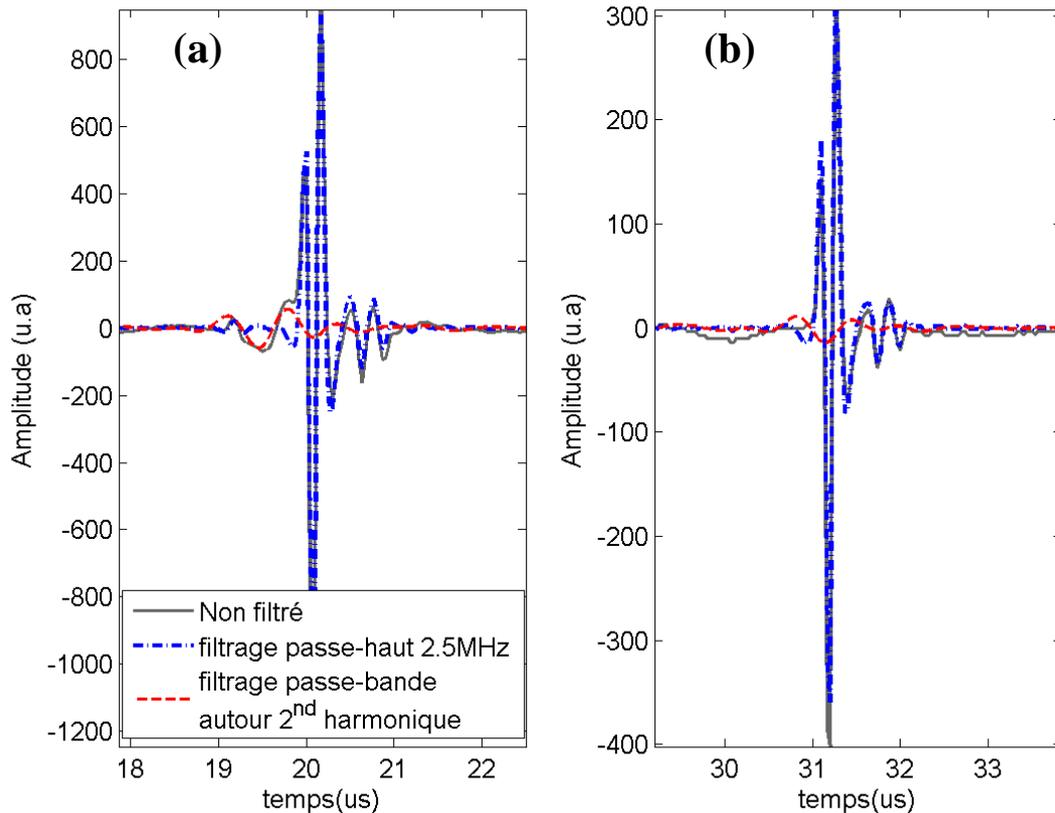
**Figure III-16 (Gel de gélatine 1) Signaux radiofréquences enregistrés passivement pendant le 3<sup>ième</sup> tir par le 65<sup>ième</sup> élément de la barrette et correspondant au (a) premier front et (b) au second front. Le filtrage s'effectue avec des filtres FIR de Butterworth d'ordre 3. Les fréquences de coupure pour le filtre passe-bande sont 0.82MHz et 1.82MHz.**
