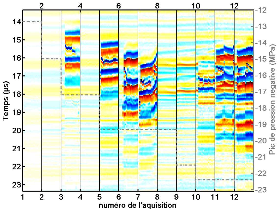
*Figure IV-33 Signaux RF passif collectés sur la voie de réception 32 du réseau de détection. Les signaux ne sont pas filtrés, mais on choisit d'afficher une fenêtre temporelle comportant uniquement les premiers signaux de bulle. La ligne en escalier grise correspond à la valeur du pic de pression négative au foyer du monoélément de thérapie pour chaque acquisition.*
