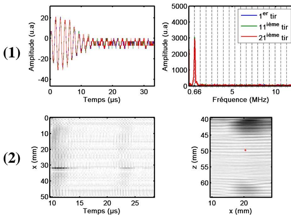
**Figure IV-5** Données passives correspondant à une acquisition pour laquelle aucun évènement de nucléation de bulles n'est détecté. (1) présente les signaux radiofréquences bruts enregistrés sur le 65<sup>ième</sup> traducteur du réseau et l'amplitude de la transformée de Fourier correspondant pour les tirs numéro : 1, 11 et 21. (2) Bscan passif (à gauche) et image passive synchronisée (à droite) pour le premier tir.
