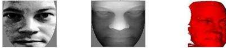
Figure 1-5. Trois représentations du visage: image 2D en niveau de gris, image de profondeur, et modèle surfacique
