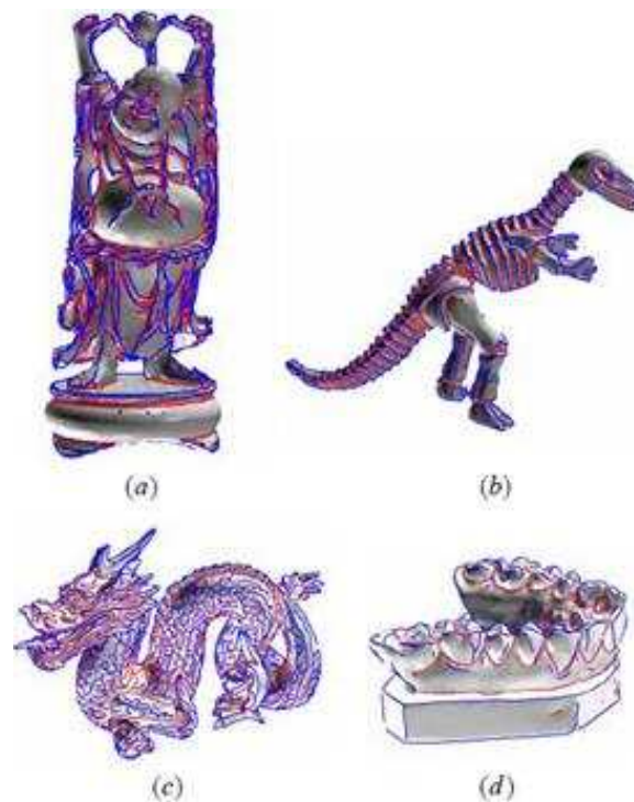
Figure 2-10. Extraction des crêtes (en bleu) et des ravines (rouge) sur différents modèles (Song, et al., 2005)
