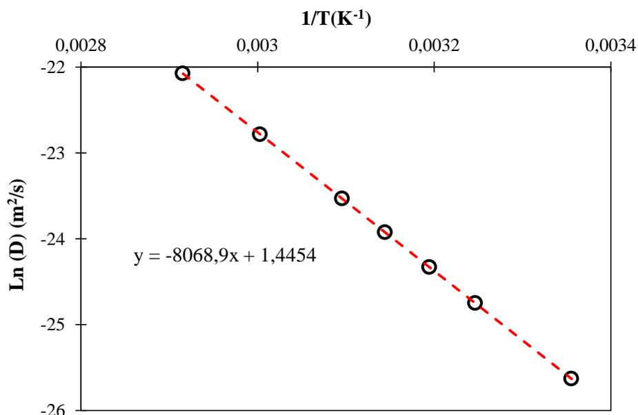
Figure 3-11 : Graphe d'Arrhenius du coefficient de diffusion d'eau dans le PA 6,6 à 100% HR entre 25 et 70°C.
