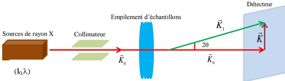
Figure 2-14 : Schéma de diffusion des rayons X.
