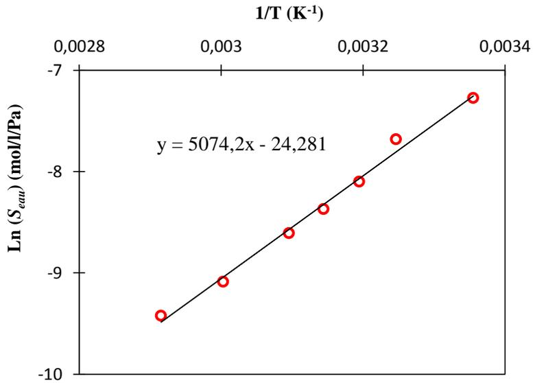
Figure 3-4 : Graphe d'Arrhenius du coefficient de solubilité d'eau dans le PA 6,6 entre 25 et 70°C pour HR ≤ 50%.
