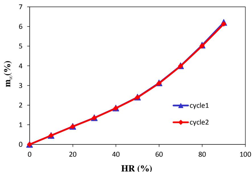
Figure 3-2: Isothermes de sorption à 50°C pour deux cycles de sorption-désorption successifs.
