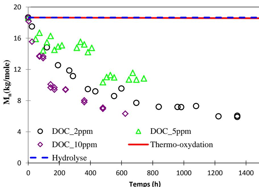
Figure 6-4 : Evolution de la masse molaire moyenne en nombre ( $M_n$ ) du PA 6,6 à 17°C dans différentes solutions de DOC (2, 5 et 10 ppm). Comparaison avec l'évolution de  $M_n$  dans l'eau distillée (hydrolyse) et l'air (thermo-oxydation) à la même température.
