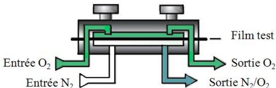
Figure 2-21 : Chambre de mesure de perméation.
