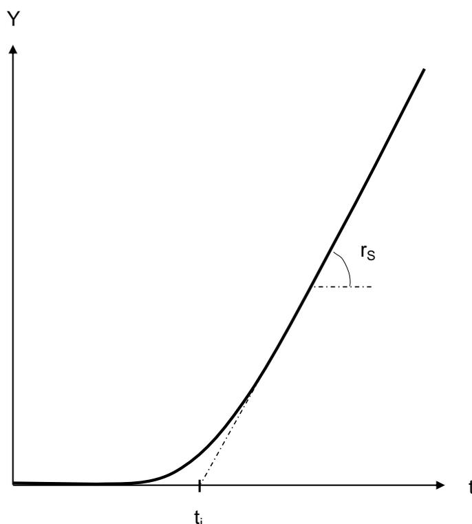
*Figure 5-1: Forme générale des courbes cinétiques d'oxydation des polymères hydrocarbonés. Y désigne une grandeur chimique qui change au cours du vieillissement thermique. Détermination graphique du temps d'induction ( $t_i$ ) et de la vitesse maximale d'oxydation ( $r_s$ ).*
