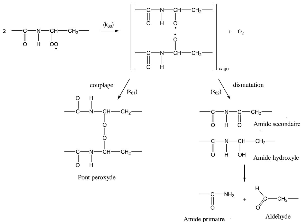
Mais, des études récentes portant sur la cinétique d'oxydation du PE ont montré que la terminaison des radicaux peroxyde secondaires n'est pas très efficace [36]. En effet, une partie non négligeable des paires de radicaux alkoxyde peuvent s'échapper de la cage pour amorcer de nouvelles chaînes d'oxydation radicalaire. Ainsi, la combinaison de paires de radicaux peroxyde secondaires devrait plutôt s'écrire:
