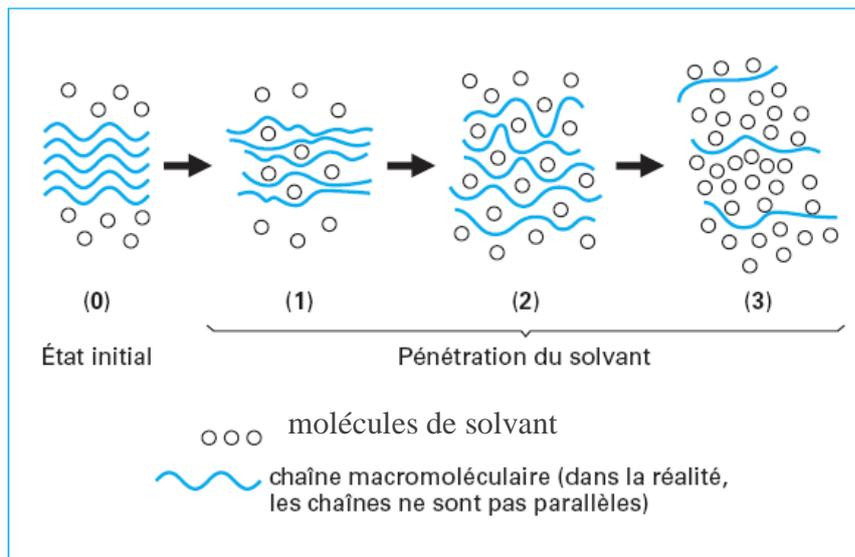
Figure 1-15 : Schématisation de la pénétration d'un solvant dans un polymère [38].
