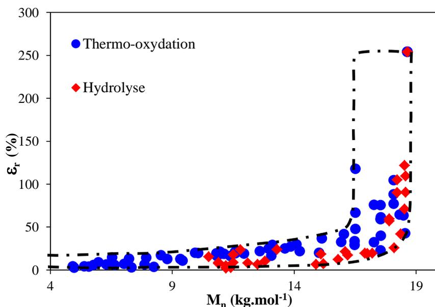
Figure 5-13 : Allongement à la rupture en fonction du masse molaire moyenne en nombre pour des films de PA 6,6 d'environ 100  $\mu\text{m}$  d'épaisseur subissant un processus prédominant de coupures de chaîne dans l'air entre 90 et 160°C ou dans l'eau distillée entre 60 et 90°C.
