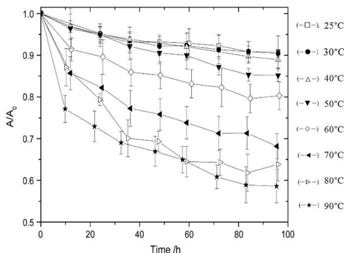
Figure 1-23 : Evolution de l'absorbance du pic à  $3080\text{ cm}^{-1}$  en fonction du temps d'immersion dans l'eau distillée entre 25 et  $90^{\circ}\text{C}$  [46]. L'absorbance de ce pic a été normalisée par sa valeur initiale.
