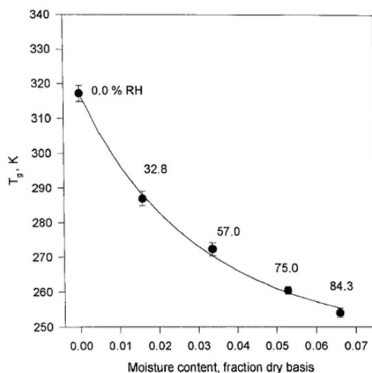
Figure 1-10: Evolution de la T<sub>g</sub> du PA 6,6 en fonction du pourcentage d'humidité relative à 25°C [22].
