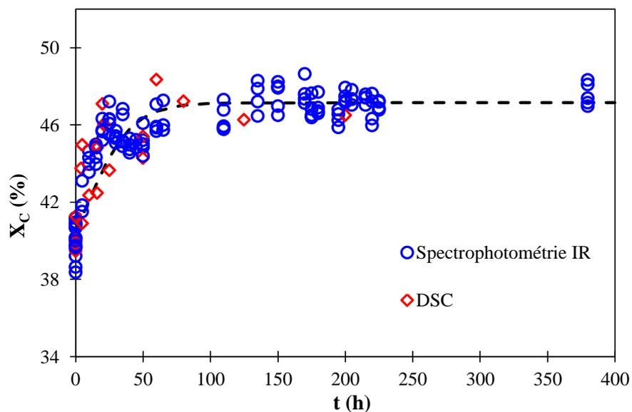
Figure 4-5 : Evolution du taux de cristallinité du PA 6,6 pendant son vieillissement hydrolytique dans l'eau distillée à 90°C. Comparaison des résultats obtenus par spectrophotométrie IR et DSC.
