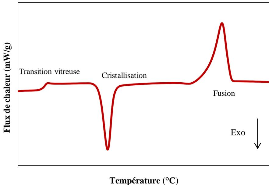
Figure 2-11 : Thermogramme DSC général d'un polymère semi-cristallin.
