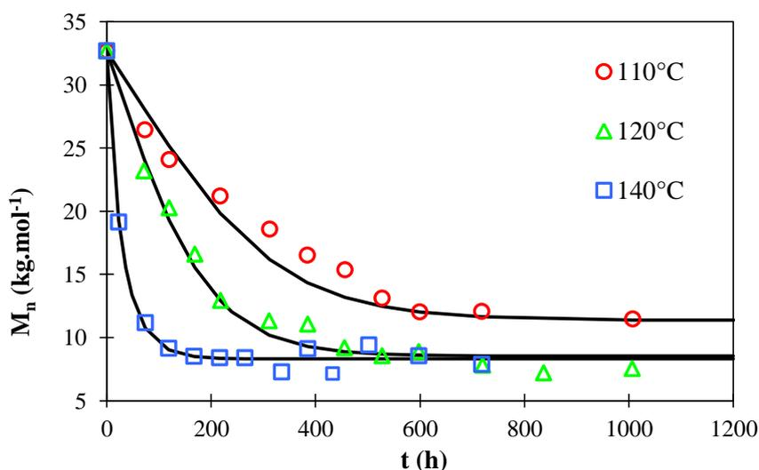
Figure 4-9 : Evolution avec le temps d'exposition de la masse molaire moyenne en nombre du PA 11a à 110, 120 et 140°C dans l'eau distillée d'après [11]. Simulation des points expérimentaux par l'Equ. 4-35 (traits continus).
