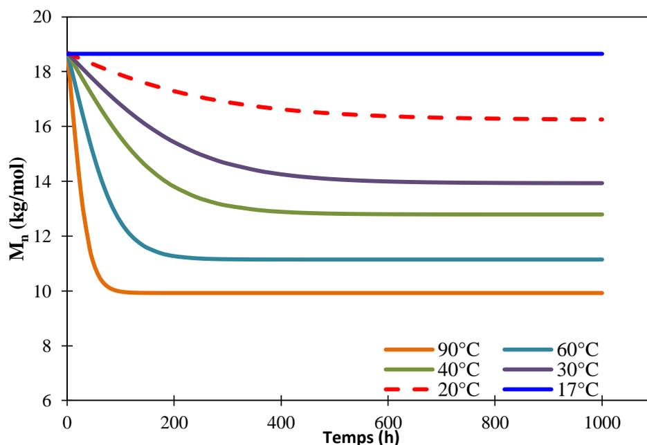
Figure 6-1 : Evolution de la masse molaire moyenne en nombre ( $M_n$ ) du PA 6,6 dans l'eau distillée entre 17 et 90°C. Simulations effectuées à l'aide de l'Equ 4-34 et des valeurs des paramètres cinétiques du Tableau 4-4.
