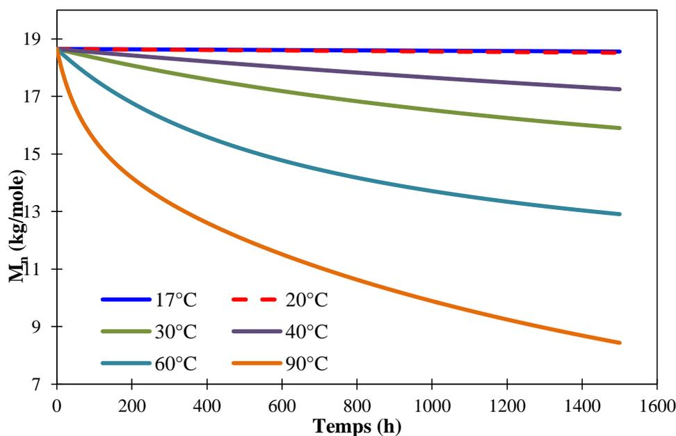
Figure 6-2 : Evolution de la masse molaire moyenne en nombre ( $M_n$ ) du PA 6,6 dans l'air entre 17 et 90°C. Simulations effectuées à l'aide de l'Equ. 5-25 et des valeurs des paramètres cinétiques du Tableau 5-6.
