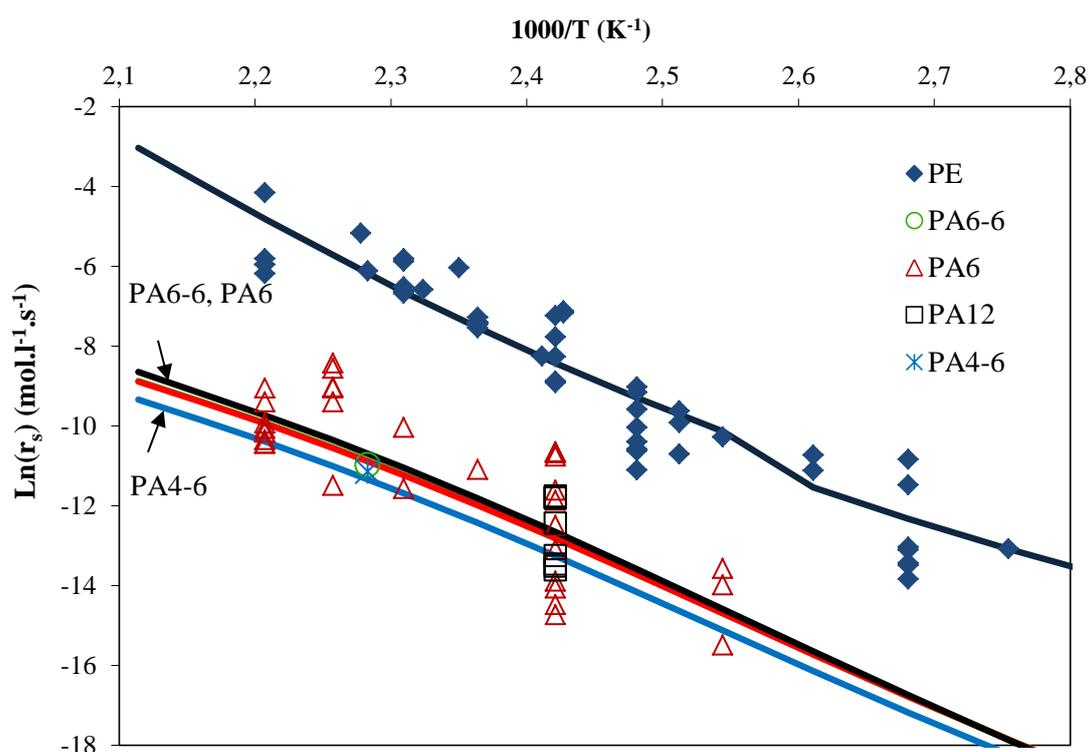
Figure 5-15: Graphe d'Arrhenius de la vitesse maximale d'oxydation ( $r_s$ ) des PAs aliphatiques et du PE purs dans l'air ou l'oxygène pur (sous pression atmosphérique) entre 90 et 200°C. Comparaison entre la théorie (traits continus) et de l'expérience (symboles).
