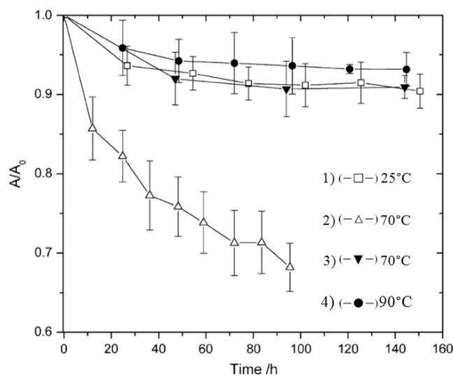
Figure 1-24 : Evolution de l'absorbance du pic à  $3080\text{ cm}^{-1}$  en fonction du temps d'exposition. L'absorbance de ce pic a été normalisée par sa valeur initiale. 1) et 2) : film du PA 6,6 exposé dans une eau distillée à 25 et  $70^{\circ}\text{C}$  respectivement, 3) film du PA 6,6 exposé dans une eau désoxygénée à  $70^{\circ}\text{C}$ , 4) film du PA 6,6 exposé dans une eau saturée en 8-hydroxyquinoline [46].
