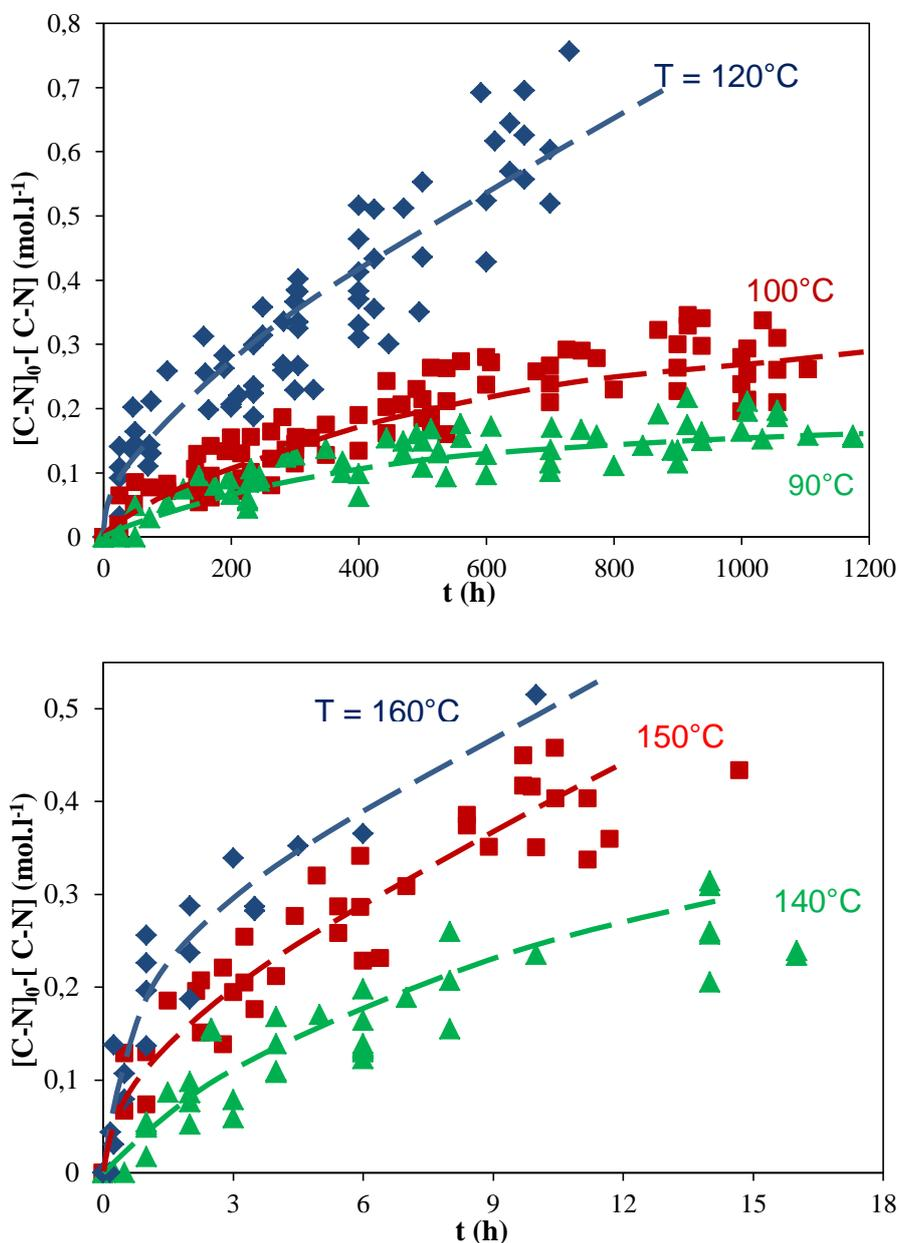
Figure 5-7 : Evolution en fonction du temps de la concentration de liaisons C-N rompues du PA 6,6 dans l'air entre 90 et 120°C (en haut) et entre 140 et 160°C (en bas).
