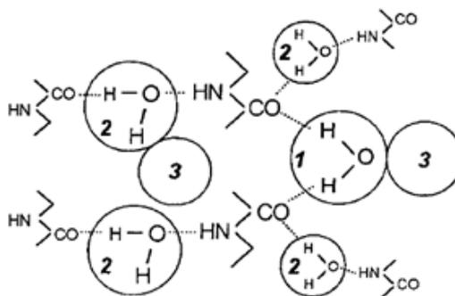
Figure 1-9 : PA 6,6 exposé à l'eau. 1) Molécules d'eau fortement liées ; 2) Molécules d'eau faiblement liées ; 3) Agrégats d'eau [20].
