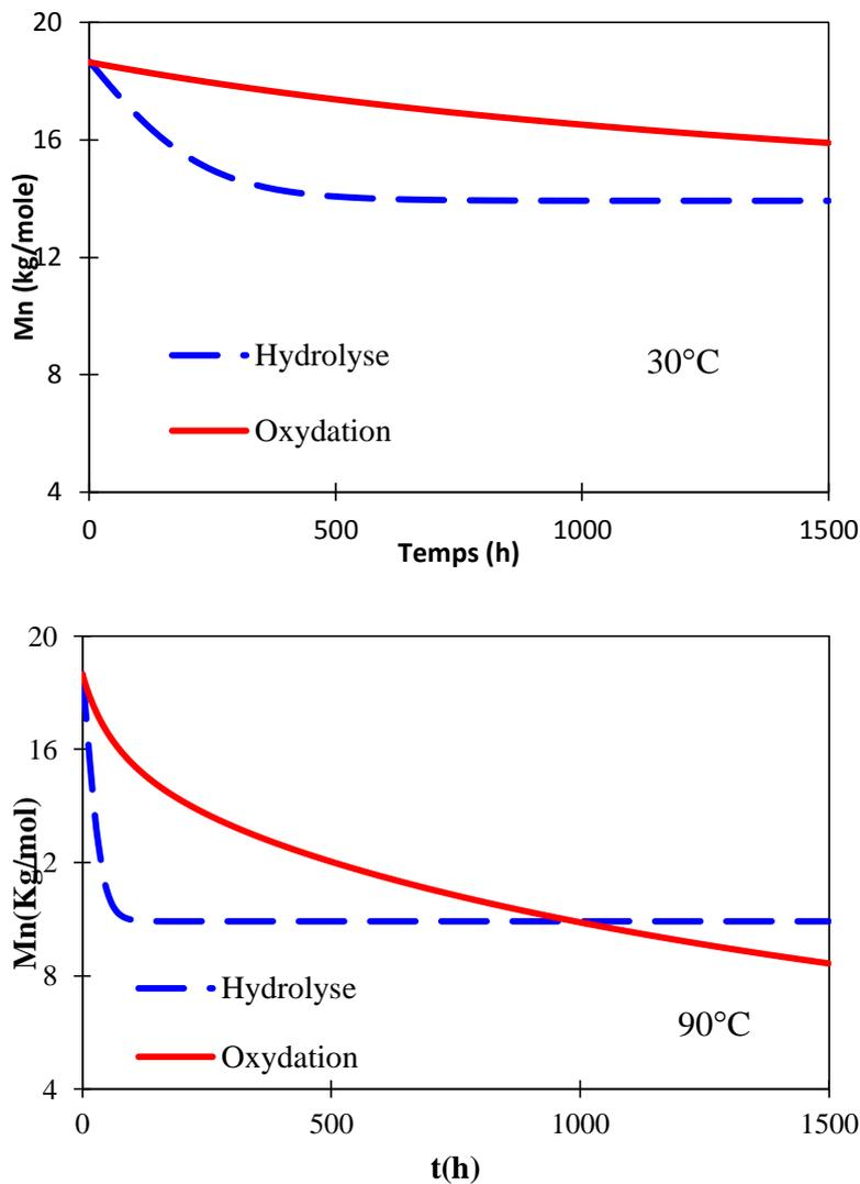
Figure 6-3 : Comparaisons des cinétiques d'hydrolyse dans l'eau distillée et de thermo-oxydation dans l'air du PA 6,6 à  $30^\circ\text{C}$  (en haut) et à  $90^\circ\text{C}$  (en bas).
