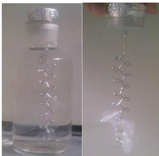
Figure 2-7 : Fiole de vieillissement hydrolytique.
