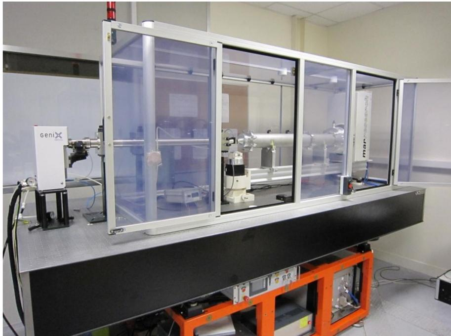
Figure 2-16 : Photographie du montage du SAXS.
