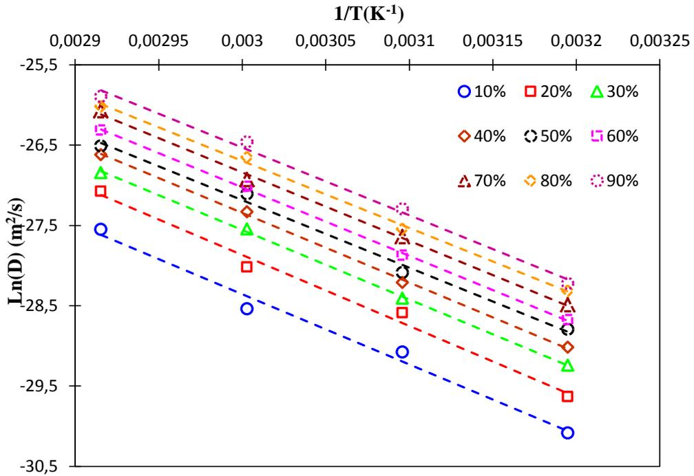
Figure 3-9 : Graphe d'Arrhenius du coefficient de diffusion d'eau dans le PA 6,6 entre 40 et 70°C entre 10 et 90 % HR.
