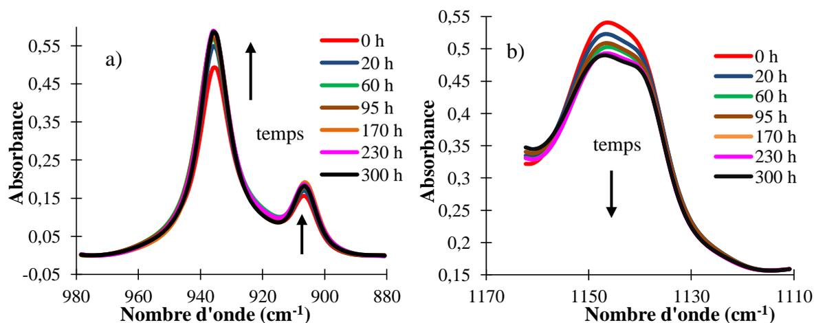
Figure 4-2 : Changement des absorbances des pics IR de la phase cristalline (a) et la phase amorphe (b) après vieillissement à 80°C dans l'eau distillée. Mesure réalisée sur un film de PA 6,6 de 45 $\mu\text{m}$  d'épaisseur.
