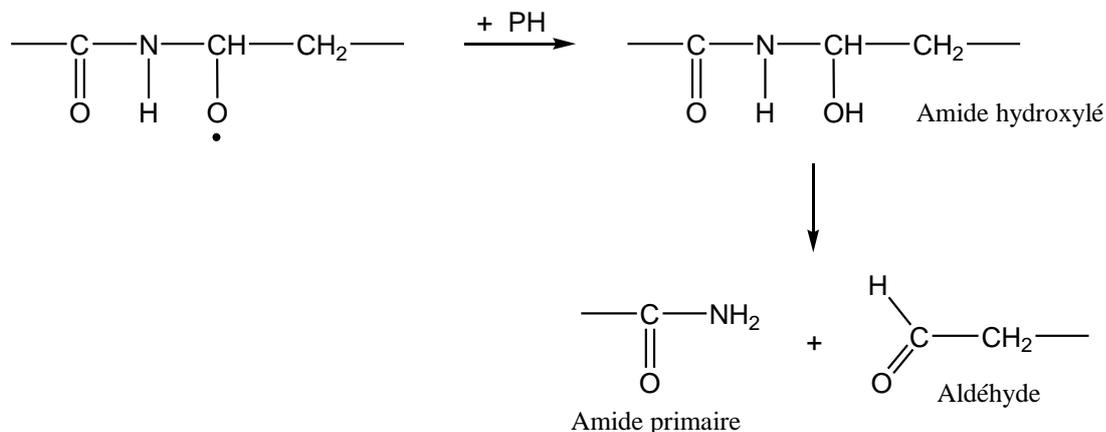
En revanche, les radicaux  $^\bullet\text{OH}$  vont arracher seulement les hydrogènes labiles du polymère. En conséquence, la décomposition unimoléculaire des hydroperoxydes peut être écrite comme suit:
