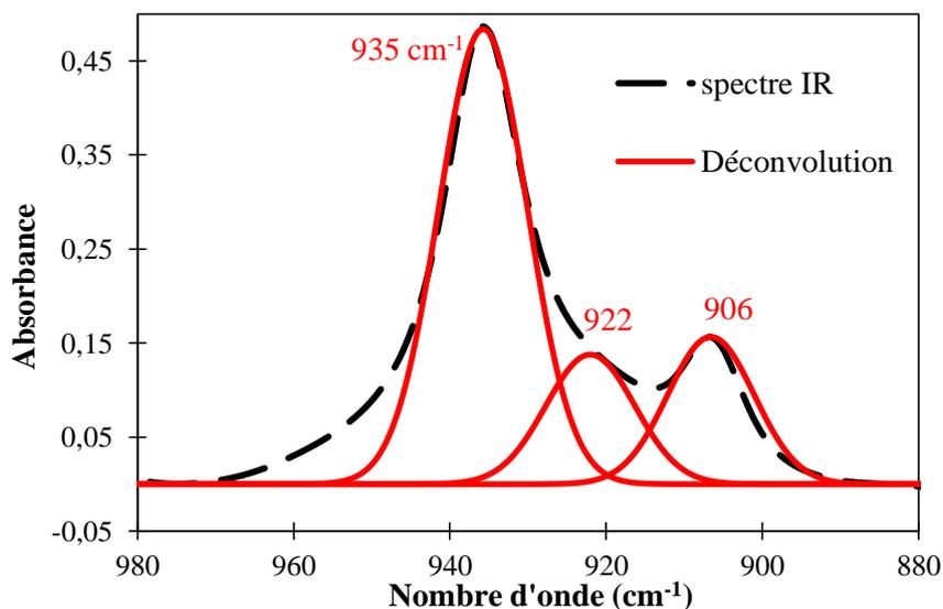
Figure 4-3 : Déconvolution du massif des bandes d'absorption du spectre IR d'un film vierge de PA 6,6 de 45  $\mu\text{m}$  d'épaisseur. Mise en évidence d'un nouveau pic situé à 922  $\text{cm}^{-1}$  et attribué à la phase amorphe du PA 6,6.
