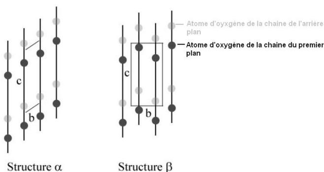
Figure 1-6 : Arrangement des plans moléculaires pour les phases  $\alpha$  et  $\beta$  du PA 6,6.
