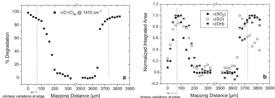
Figure 1-45 : Profils de dégradation dans un échantillon épais de PPS après 1 semaine passée dans une eau chlorée de concentration 0,2 M et un pH = 3 à température ambiante. a) Doubles liaisons C=C, b) Sulfoxydes, sulfones et hydroxyles.
