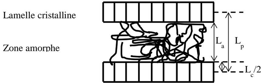
Figure 2-13 : Longueur caractéristique de répétition de la microstructure.
