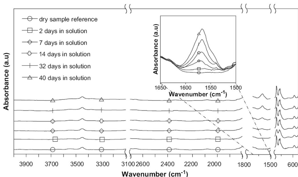
Figure 1-21 : Evolution du spectre IR 4000 et 400  $\text{cm}^{-1}$  du polyester L immergé dans une solution alcaline à  $50^\circ\text{C}$  à  $\text{pH} = 12,7$ . Un zoom de la zone IR entre 1650 et 1500  $\text{cm}^{-1}$  est présenté dans le médaillon.
