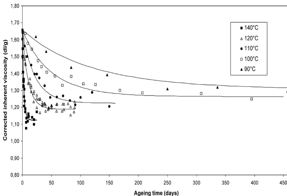
Figure 1-27 : Evolution de la viscosité intrinsèque du PA 11 en immersion dans l'eau pure entre 90 et 140°C [48].
