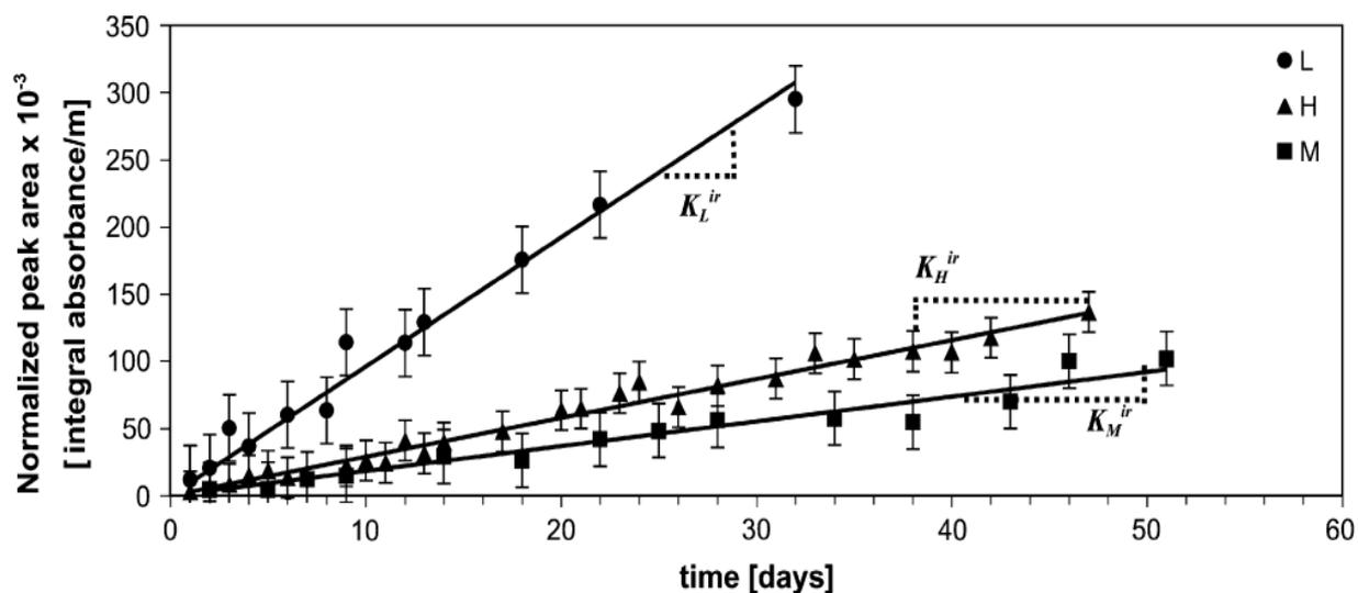
Figure 1-22 : Absorbance du pic IR des acides carboxyliques en fonction du temps d'immersion des polyesters L, H et M à  $50^\circ\text{C}$  à  $\text{pH} = 12,7$ . L'absorbance a été normalisée par rapport à l'épaisseur des échantillons.
