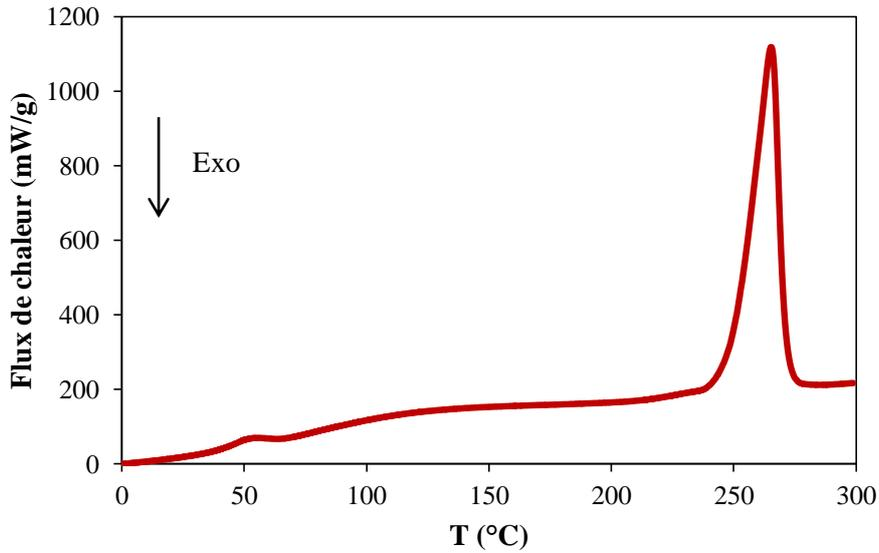
Figure 2-12 : Thermogramme DSC du PA 6,6 avant vieillissement.
