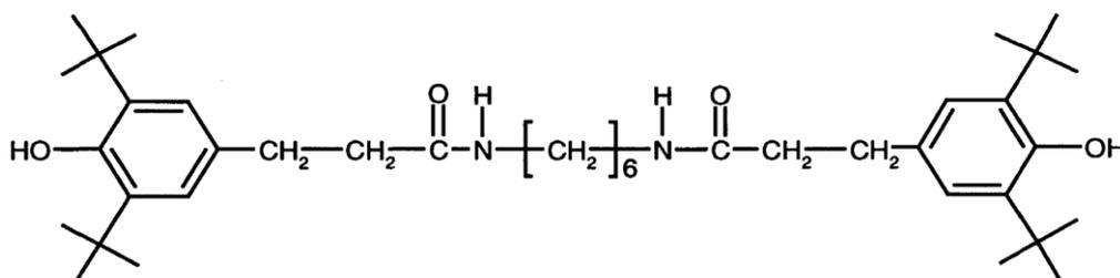
*Figure 1-38 : Structure chimique de l'Irganox 1098.*
