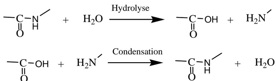
Figure 1-19 : Hydrolyse et condensation des polyamides.
