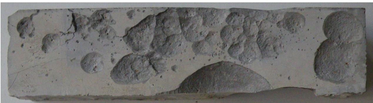
Figure 3.34 Coulis sans ajout présentant des éclats sphériques de surface après immersion partielle dans une solution contenant 3% de NaCl et soumis à 4 cycles de type écaillage (1 cycle par jour)
