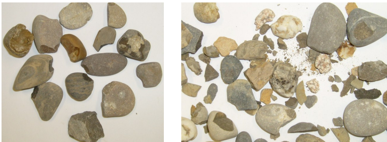
Figure 2.32 Fractionnement au gel des granules dans l'eau (à droite) et dans une solution à 3% de NaCl (à gauche)
