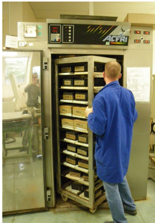
Figure A. 34 Entrée en enceinte climatique des corps d'épreuve
