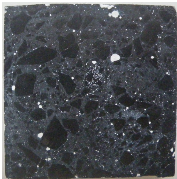
Figure A. 22 Plaque polie, encrée et aluminée
