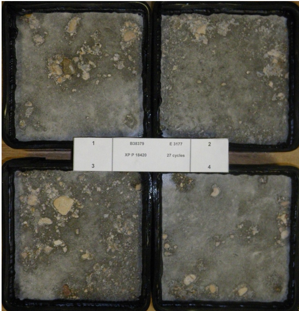
Figure A. 41 Formule B1 –Essai 3177 – Résultats et illustration des corps d'épreuve à 27 cycles
