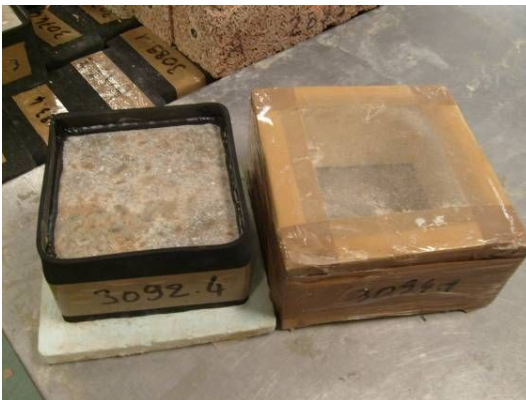
Figure A. 33 Illustration d'une éprouvette et de son capot isolant.
