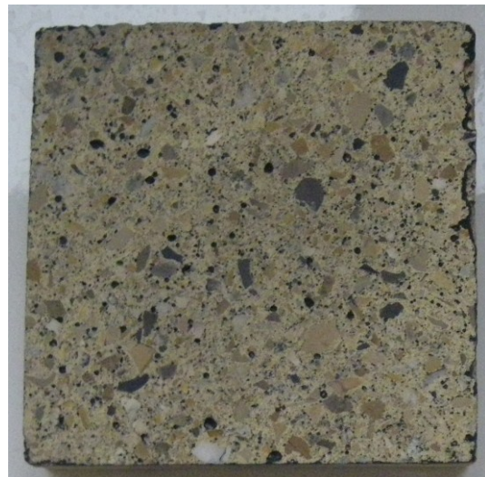
Figure A. 18 Coloration à l'encre à alcool noire
