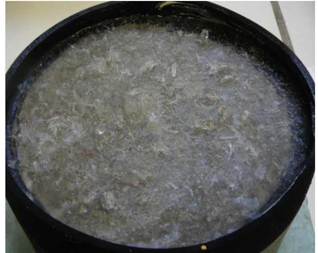
Figure 2.65 Fragmentation de la première couche de glace dont les cristaux présentent un arrangement désordonné après consolidation de l'ensemble du système NaCl-H 2 O à -20°C
