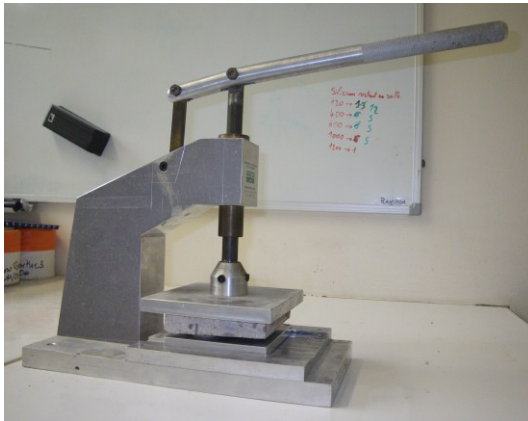
Figure A. 23 Mise sous presse d'une plaque pour le comptage manuel
