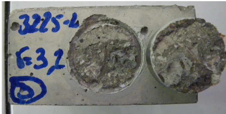
Figure 2.26 Évaluation de la traction par adhérence sur la face latérale de l'essai 3225-4
