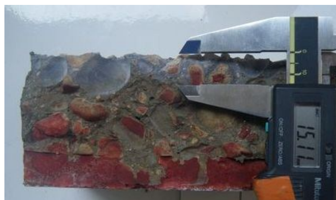
Figure A. 50 Prise de mesure après révélation par colorimétrie (essai 3179-1)
