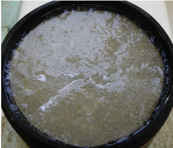
Figure 2.64 Rupture de la première couche de glace et recouvrement par la phase liquide
