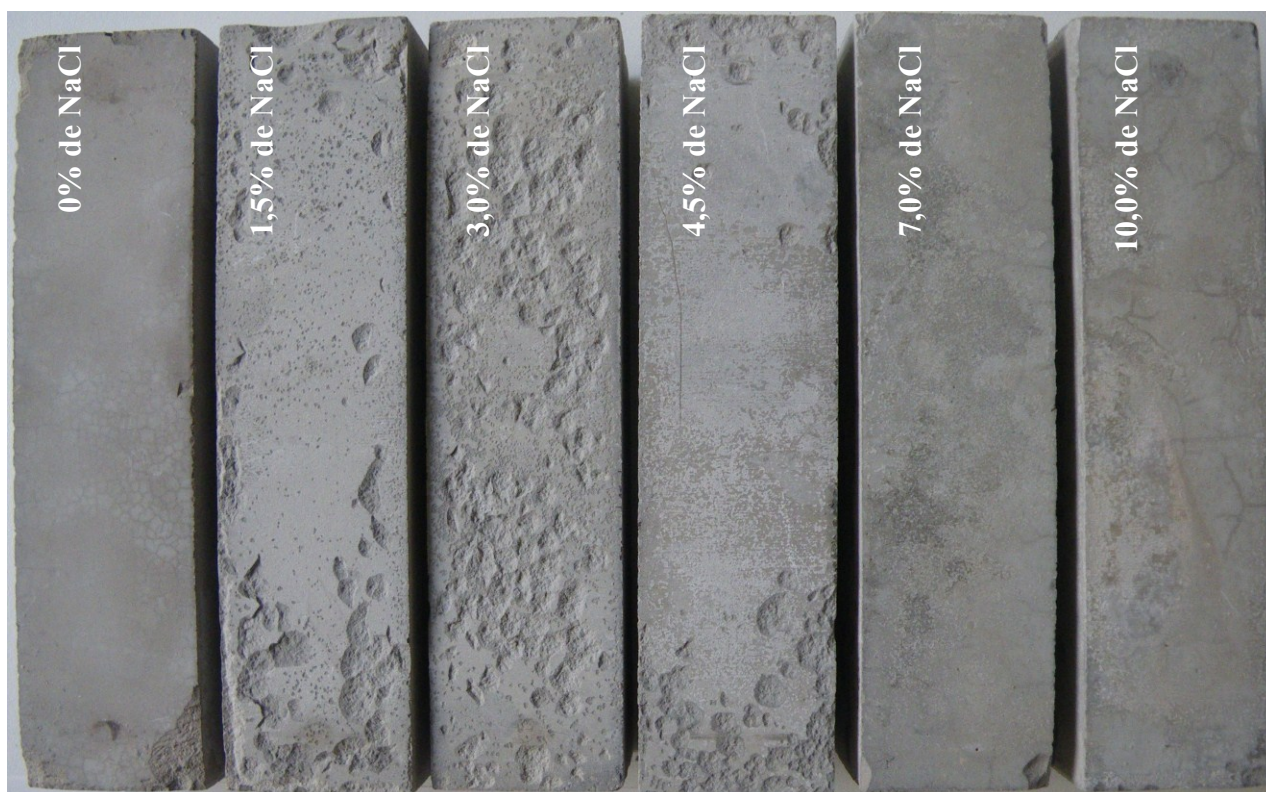
Figure 2.107 Série C.p.4.(6x3)-0,44-1-0-0 – dégradation des faces fond de moule à 250 cycles
