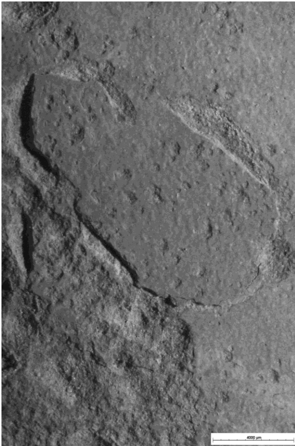
Figure 3.36 Éclat de surface (dimension caractéristique de 1 cm)
