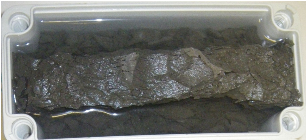
Figure 2.119 Coulis sans adjuvant ni ajout, C.p.1.(3)-0,44-0-0-0, partiellement immergé dans 3% de NaCl après 22 cycles de type écaillage (1 cycle/jour)
