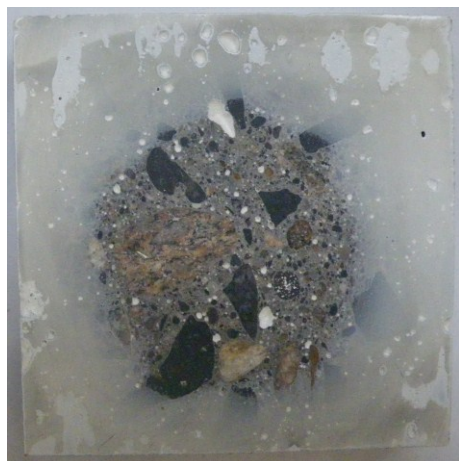
Figure A. 12 Défaut de planéité d'une plaque peinte en blanc puis polie
