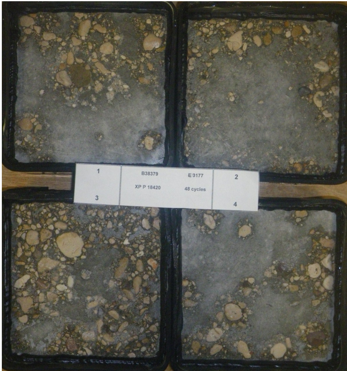
Figure A. 44 Formule B1 –Essai 3177 – Résultats et illustration des corps d'épreuve à 49 cycles
