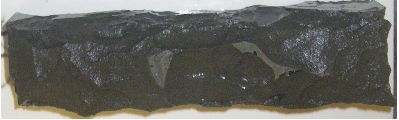
Figure 2.118 Coulis sans adjuvant ni ajout, C.p.1.(3)-0,44-0-0-0, partiellement immergé dans 3% de NaCl après 13 cycles de type écaillage (1 cycle/jour)
