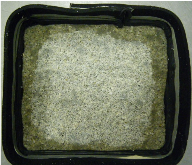
Figure 2.69 Corps d'épreuve de mortier après 299 cycles d'écaillage, face supérieure
