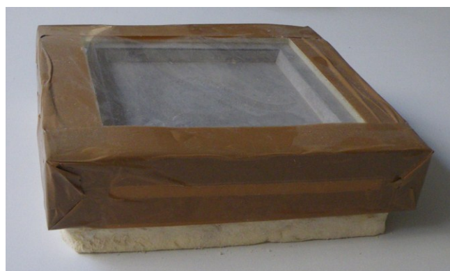
Figure 2.73 Capots isolants pour les corps d'épreuve cubiques
