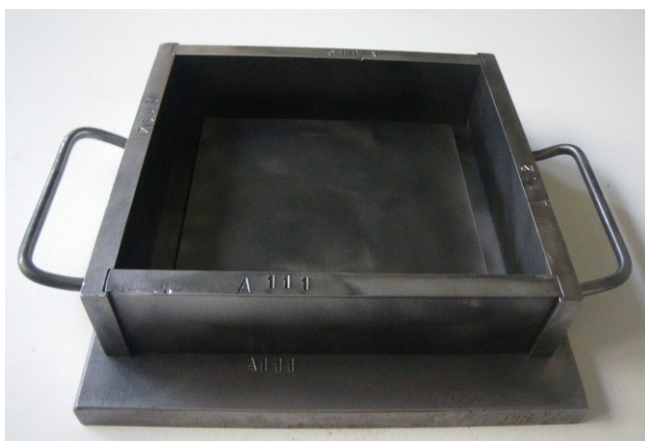
Figure 2.72 Moule métallique de fabrication des corps d'épreuve cubiques de dimensions 16x14x3,5 (en cm)
