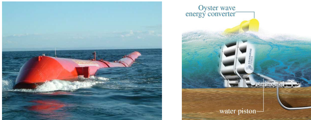
FIGURE 1.2 – Gauche : Système houlomoteur Pelamis en fonctionnement au large de l’Ecosse, [WEB02]. Droite : Schéma du système houlomoteur Oyster (Whittaker & Folley 2012).
